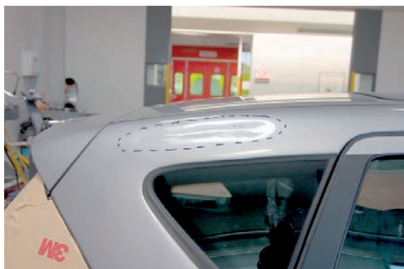
► Daño en zona de difícil acceso
