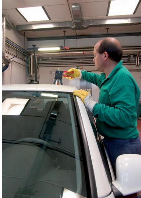
Reparación sin necesidad de repintado
