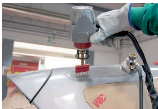
► Proceso de reparación mediante soldadura
