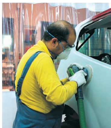
▶ Lijado en la zona de preparación
