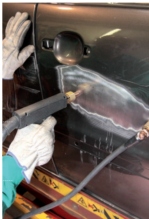
► Recogida de chapa mediante electrodo de cobre
