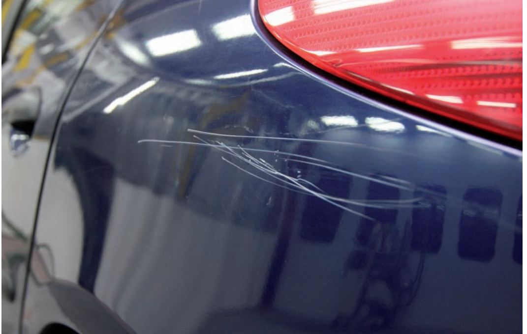
▶ Arañazo profundo con una ligera deformación
