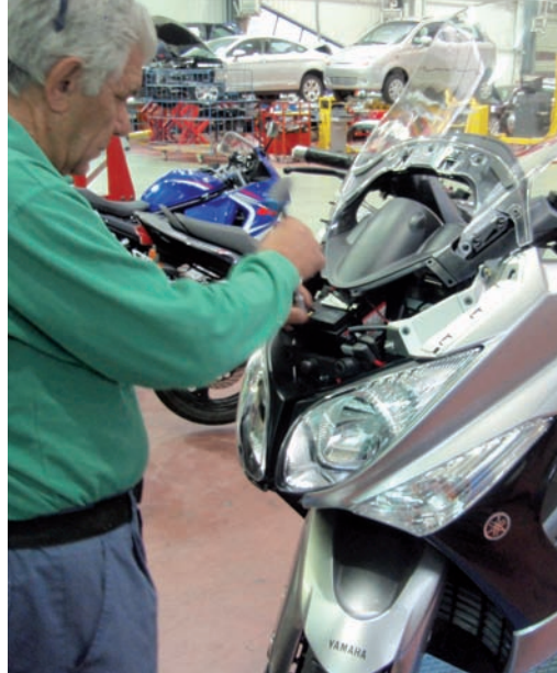
▸ Conexión de la centralita a la batería
