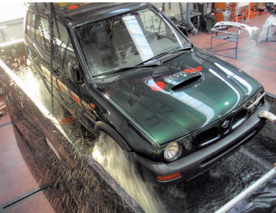
Inundación dinámica de todoterreno en CESVIMAP
