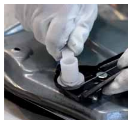
► Colocación del cable en la guía de la polea
