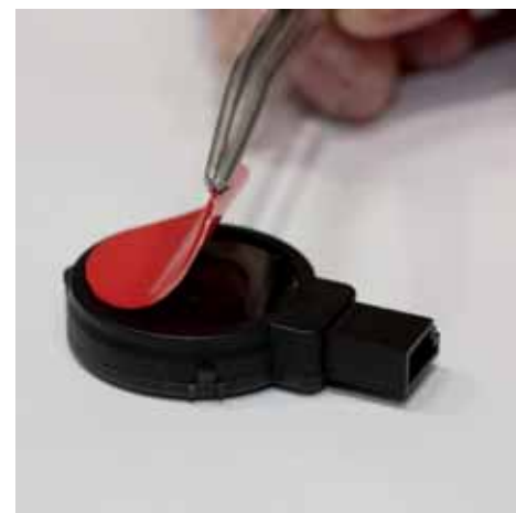
▶ Colocar el adhesivo nuevo en el sensor
