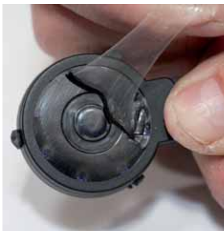
▶ Retirar el adhesivo dañado del sensor
