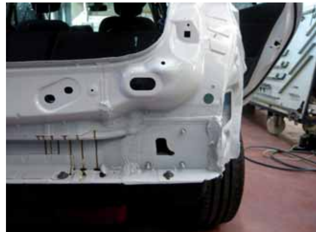
Configuración del faldón del nuevo Mégane
