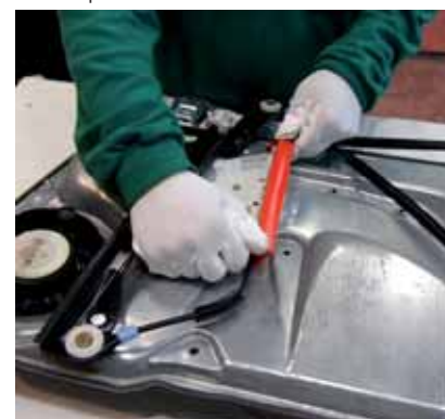
► Tensado de los muelles mediante el soporte de tensión del kit
