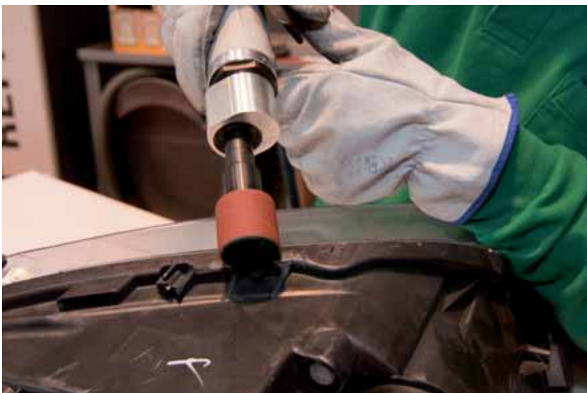
► Acondicionamiento de la patilla para la reparación
