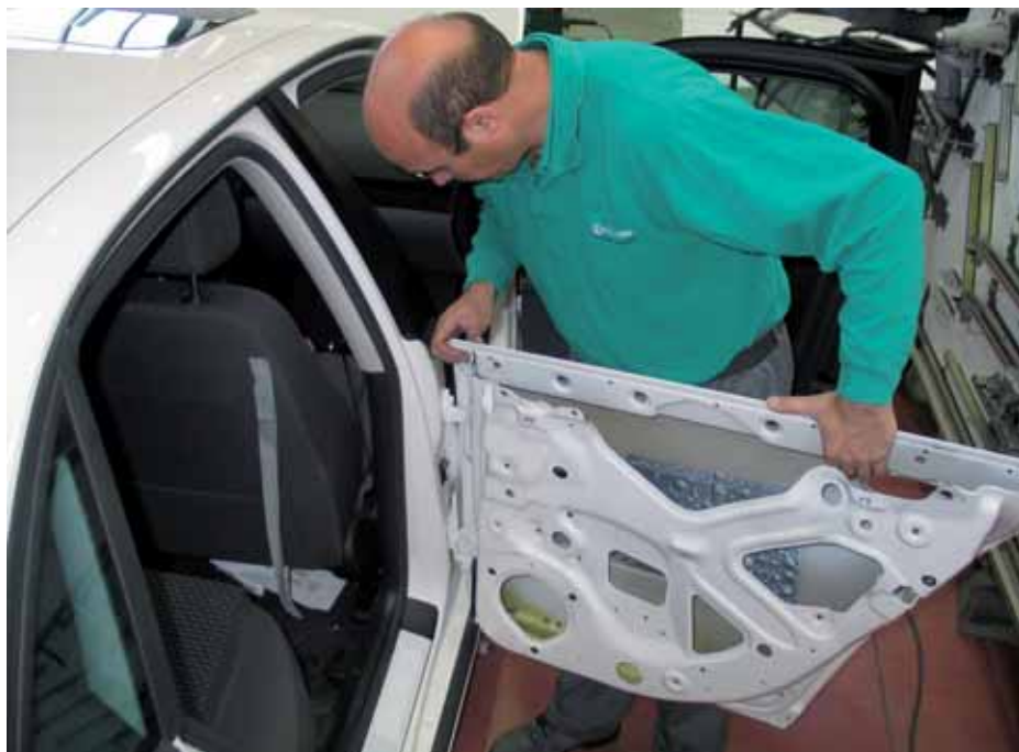
► Desmontaje de la puerta
