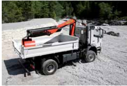
► Camión con grúa de autocarga
