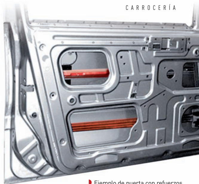
► Ejemplo de puerta con refuerzos de alto límite elástico (ALE)
