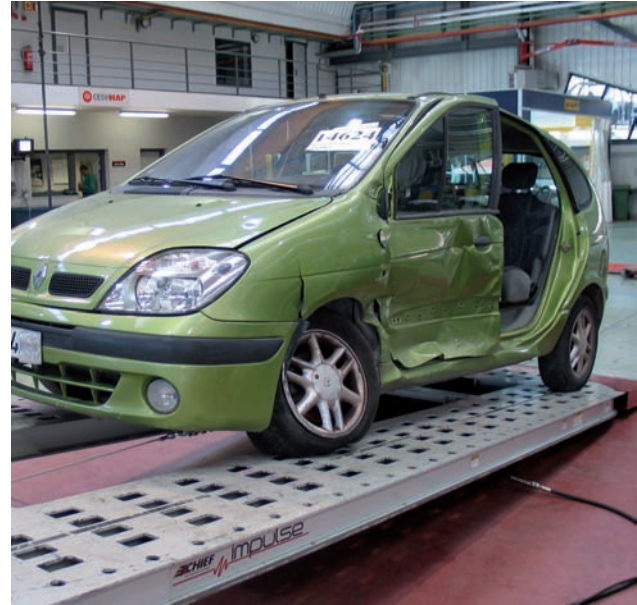
Colisión lateral con un eje afectado
