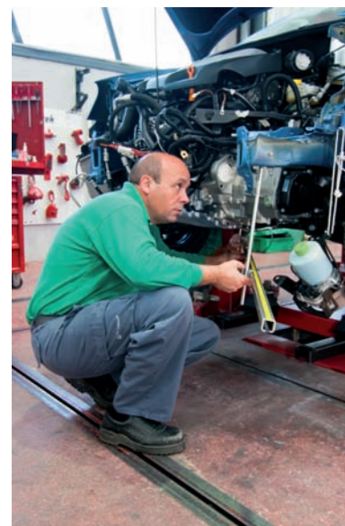
■ Verificación de cotas
