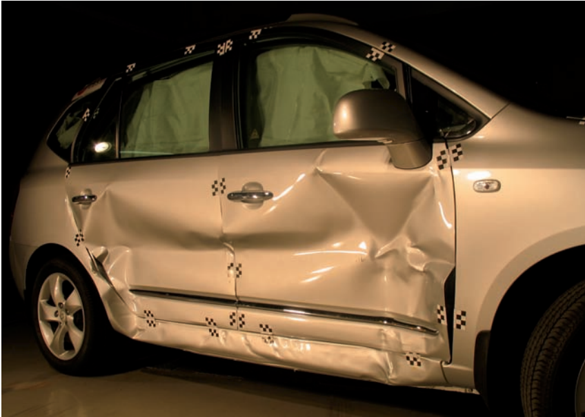
Impacto lateral entre ejes
