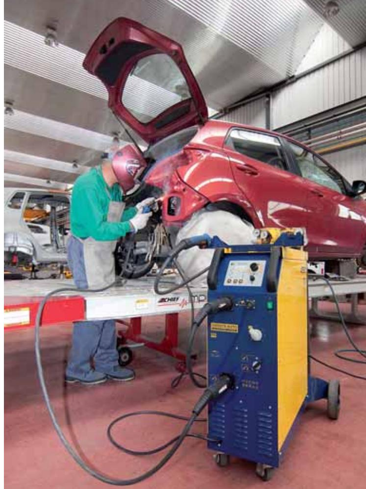
Duogys Auto ofrece la posibilidad de montar dos carretes de distinto material, con sus mangueras y sus gases protectores correspondientes, solución que evita tener que cambiar de equipo o, lo que es más engorroso, adaptar la máquina al nuevo material, cambiando el carrete, la siesga, la boquilla, etc.
