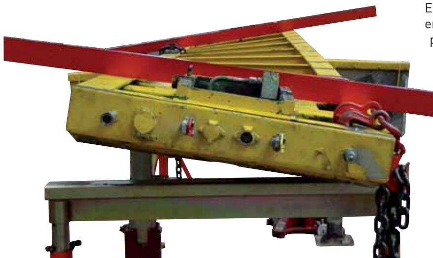
En los chasis de los semirremolques, debido a su longitud, hasta 13 metros, los desplazamientos al realizar las contratorciones de reparación pueden ser muy elevados, existiendo el peligro de que se suelten los cilindros. También hay que tener en cuenta que la zona del cuello es más débil que la parte del cuerpo, por lo que se debe evitar colocar los cilindros de empuje y las cadenas de sujeción en esa zona.
