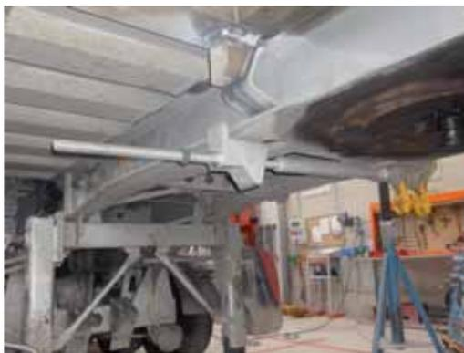
► Útil de sujeción en la placa porta *King-pin*
