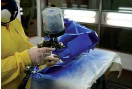
▶ Aplicación de un efecto tricapa
