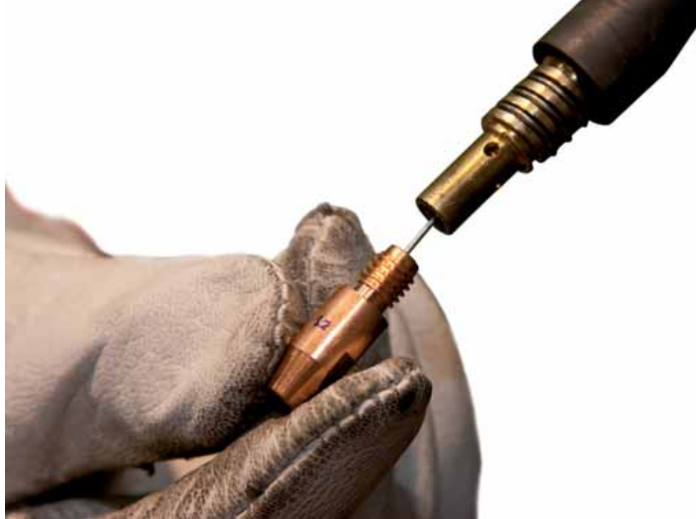
▶ Boquilla de contacto de 1,2 mm
