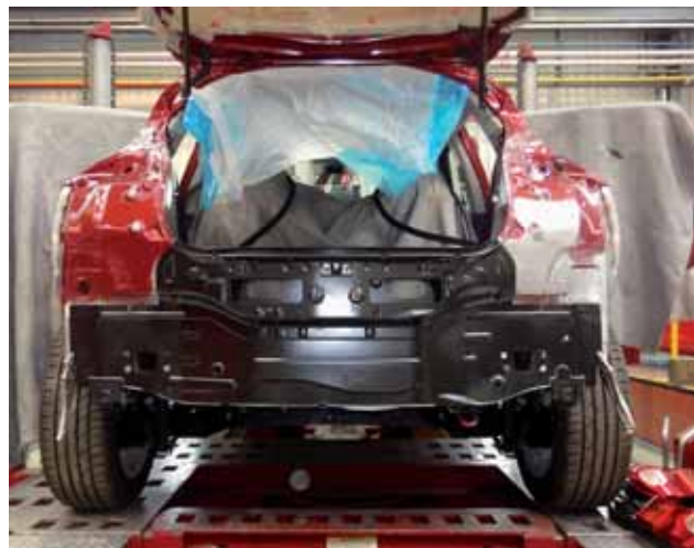
► Sustitución de faldón trasero
