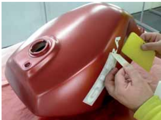
Colocación de un adhesivo y barnizado de la pieza
