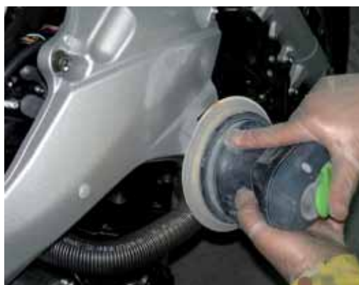
► Reparación de un daño en un chasis
