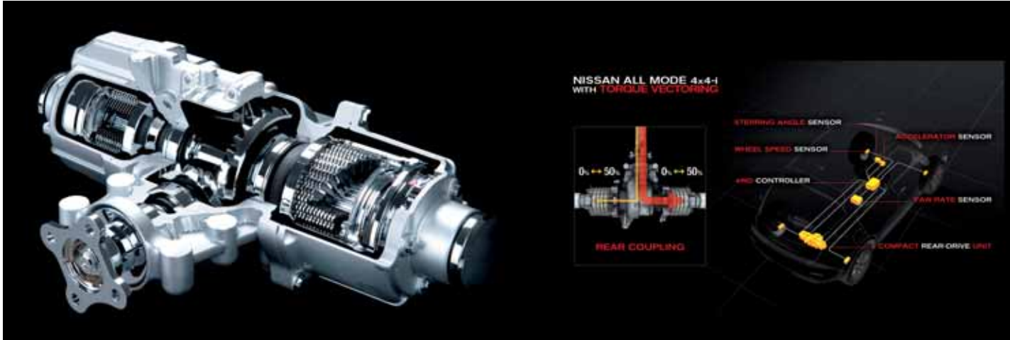
► Caja de transferencia del eje trasero para la versión 4x4
