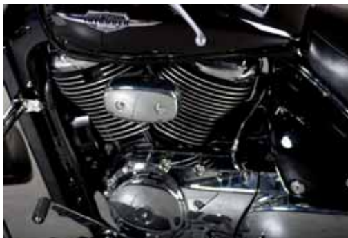
► Motor en V de alta cilindrada (800 cc)
