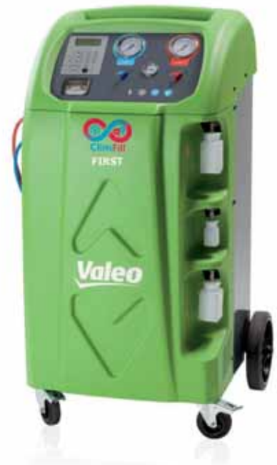
► Equipo de recuperación y recarga para R134a y R1234yf
