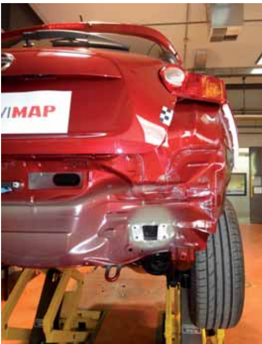
► Crash test RCAR trasero y crash test de paragolpes trasero
