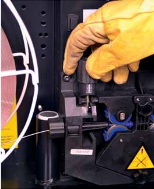
▶ Ajuste de la presión de los rodillos
