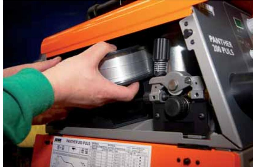
► Ajuste de los rodillos y sustitución del hilo
