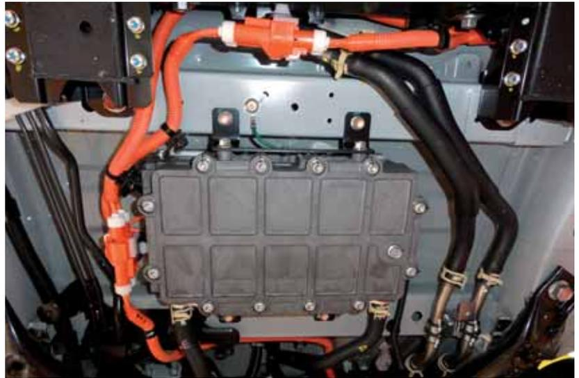
▶ Aislamiento y protección del cableado de alta tensión, de color naranja normalizado.
