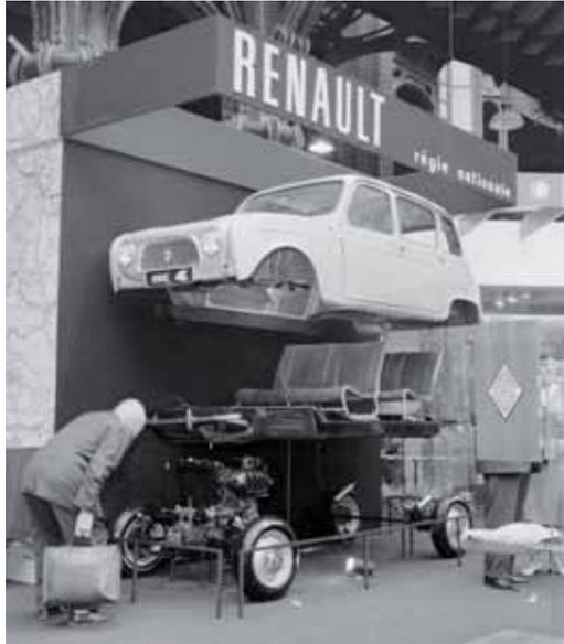
Renault 4 con carrocería chasis-plataforma
