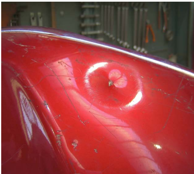
► Daño reparable mediante técnicas de tracción
