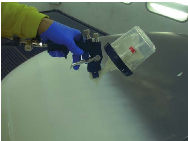
► Aplicación del aparejo h/h sobre cataforesis
