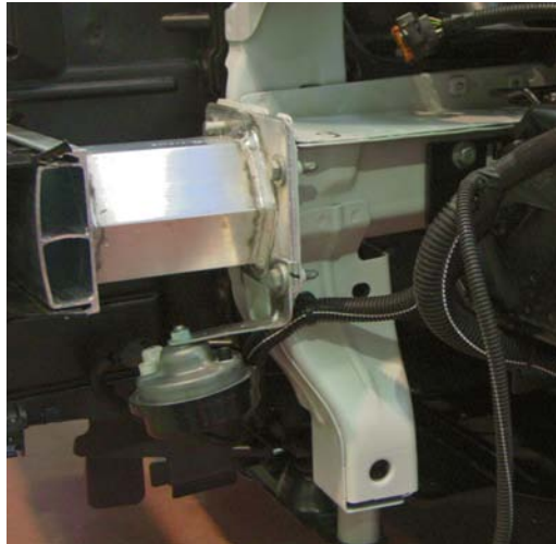
► Estructura de los largueros delanteros y travesía
