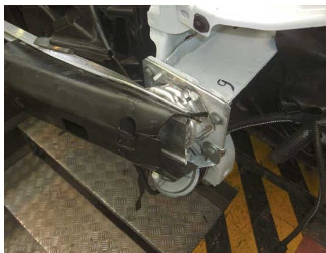
► Daños en la travesía delantera
