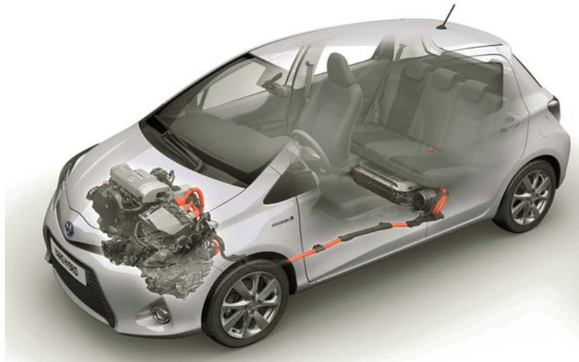
▶ Motor térmico, batería de alta tensión, cableerías y transeje híbrido de Toyota
