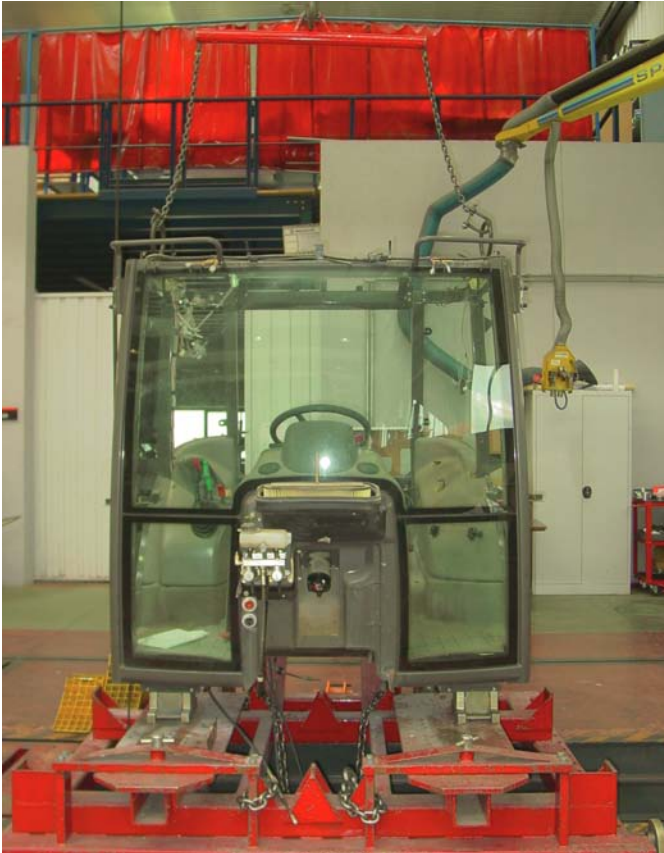
► Reparación de la cabina de un camión sobre una bancada de cabinas
