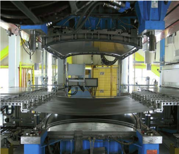
► Fabricación de un techo de fibra
