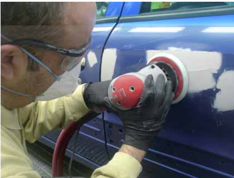
► Lijadora eléctrica de 5 mm de órbita
