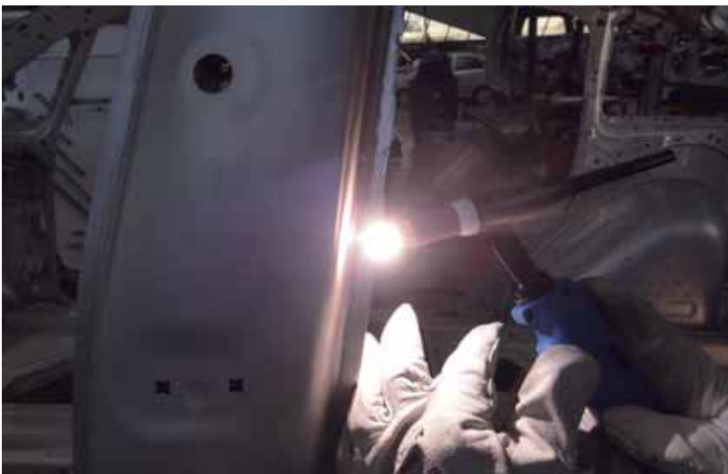
► Soldadura de bordes en chapa de aluminio
