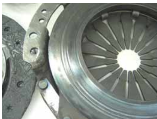
► Marcas en un embrague con desgaste irregular
