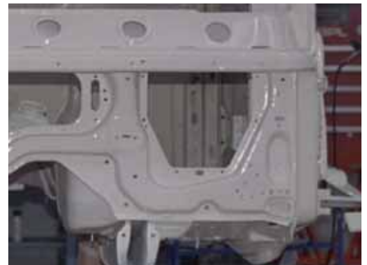
▸ Frente sin soporte para la cerradura del capó
