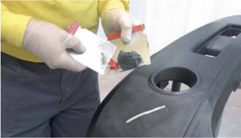
► Preparación de la mezcla de masilla
