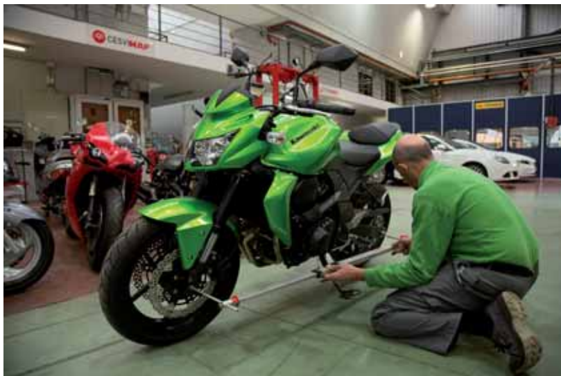
► Comprobación mediante compás de varas
