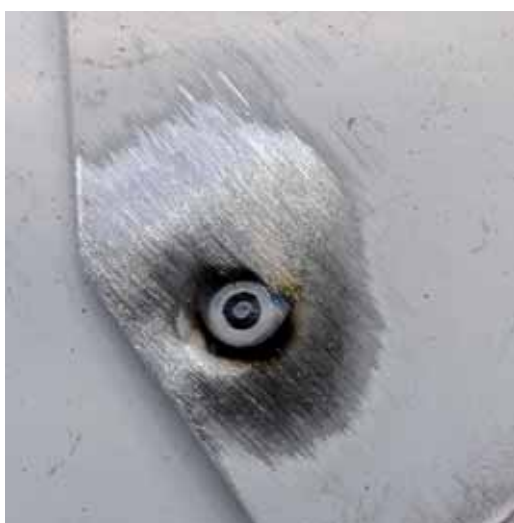
► Punto de soldadura TIG con distanciador DRT
