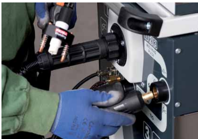
▶ Colocación de la antorcha para soldadura TIG
