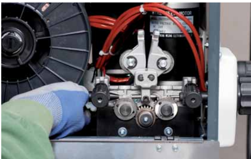
► Sistema de arrastre del hilo y comprobación de la presión de los rodillos
