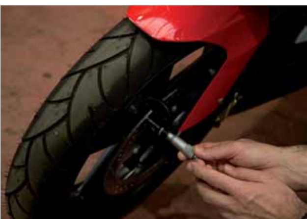
► Comprobación del espesor del disco
