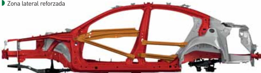
► Zona lateral reforzada
