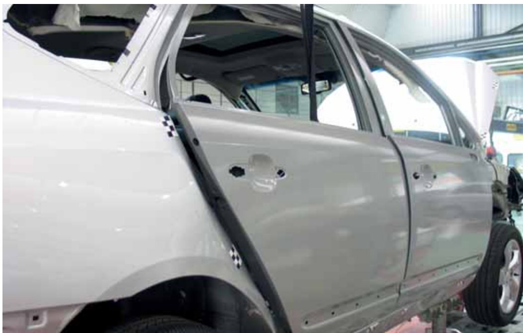
► Reparación de golpe lateral
