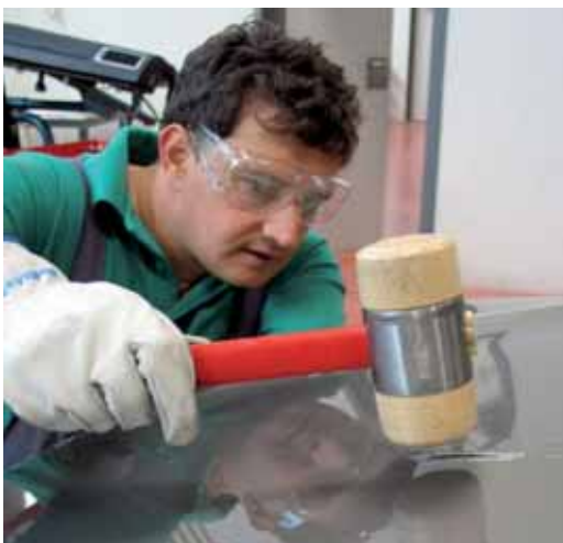
▶ Reparación de capó de aluminio
