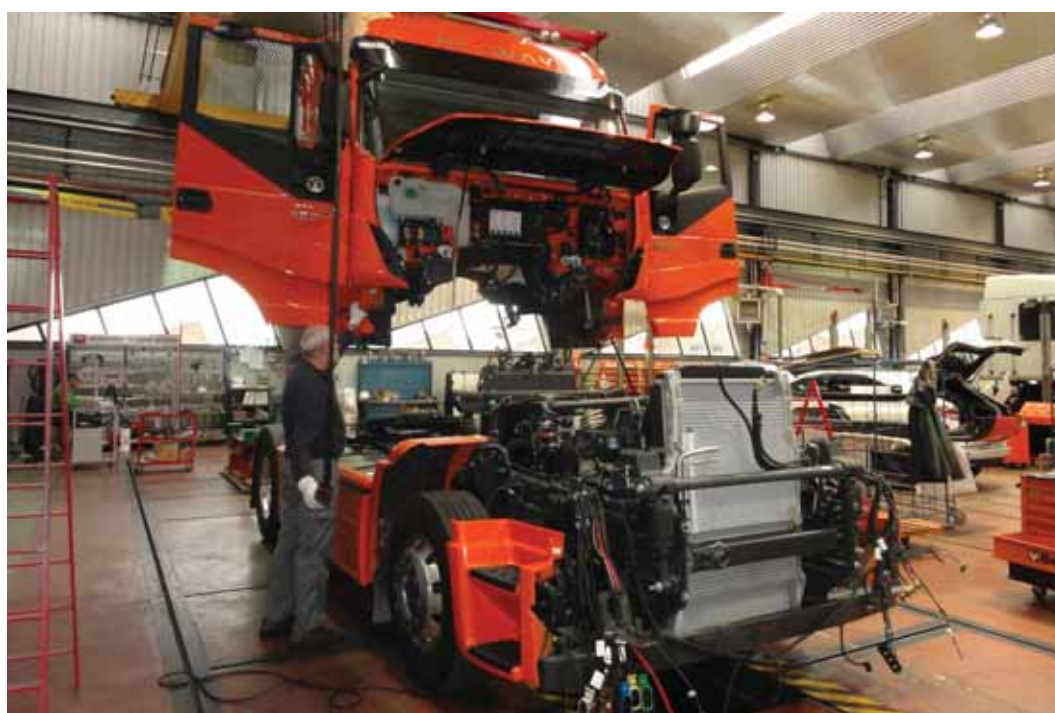
Desmontaje de cabina
