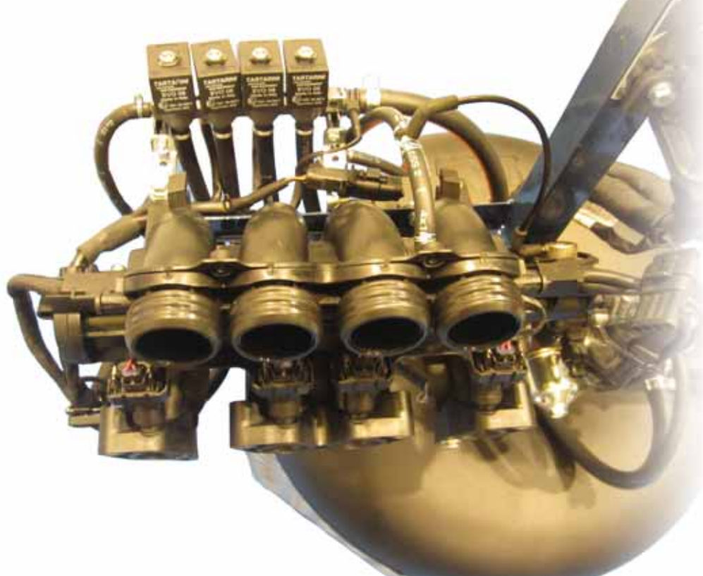
► Conjunto funcional para adaptación de vehículo a gas
