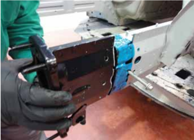
▀ Sustitución de piezas mediante pegado-remachado
