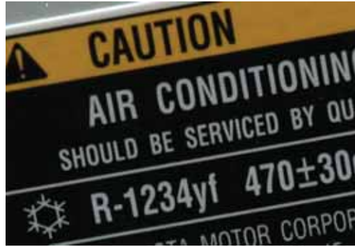
▶ Pegatina identificativa del refrigerante en el vehículo
