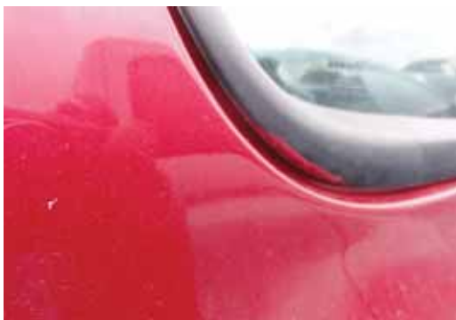
► Gomas pintadas por un enmascarado defectuoso
