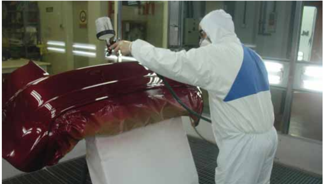
▶ Aplicación de barniz elastificado
