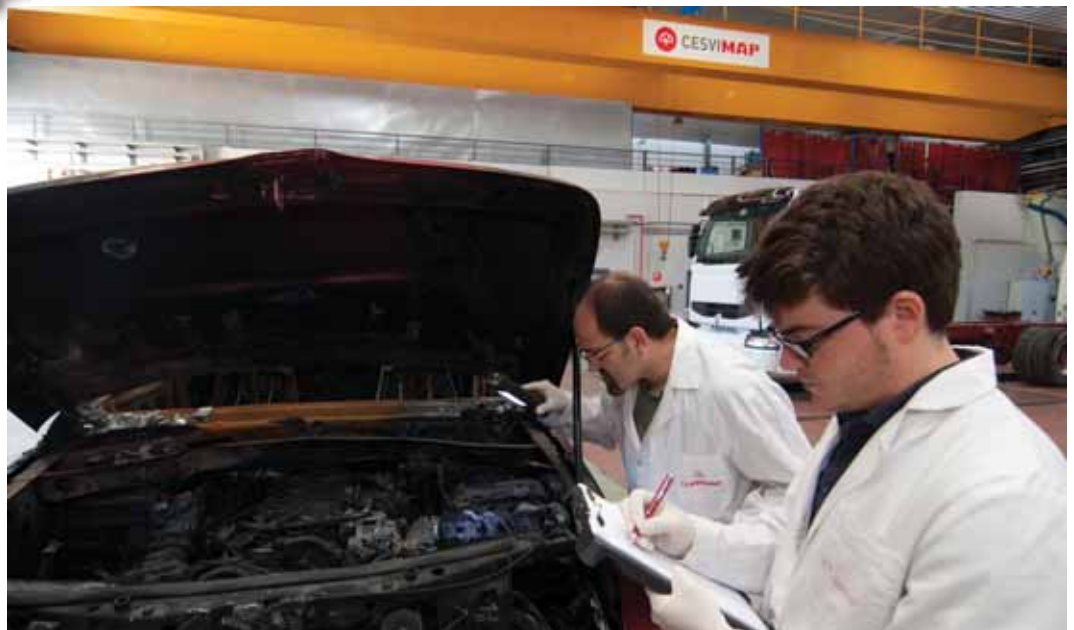
► Toma de datos y análisis del incendio en CESVIMAP
