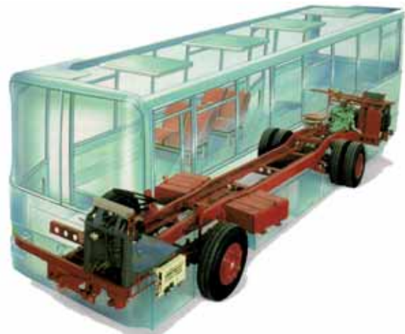
► Estructura de chasis independiente
