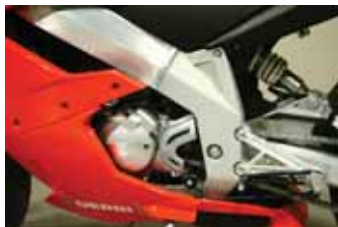
► Chasis fabricado con aleación de aluminio
