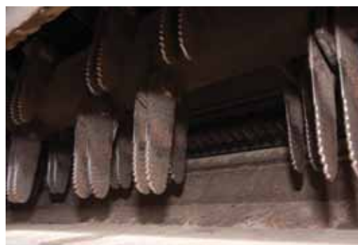
▶ Picador de cosechadora de cereal en buen estado de uso y en mal estado, a la derecha
