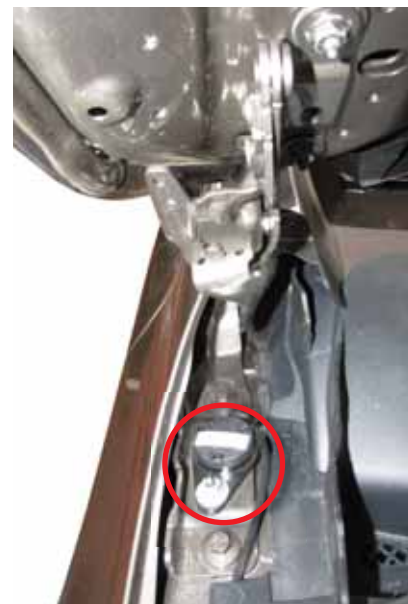
▶ Actuador de elevación de las bisagras
