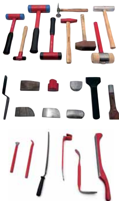
▶ Martillos para repasar, tases, tranchas, limas de carrocerero y cucharas de desabollado
