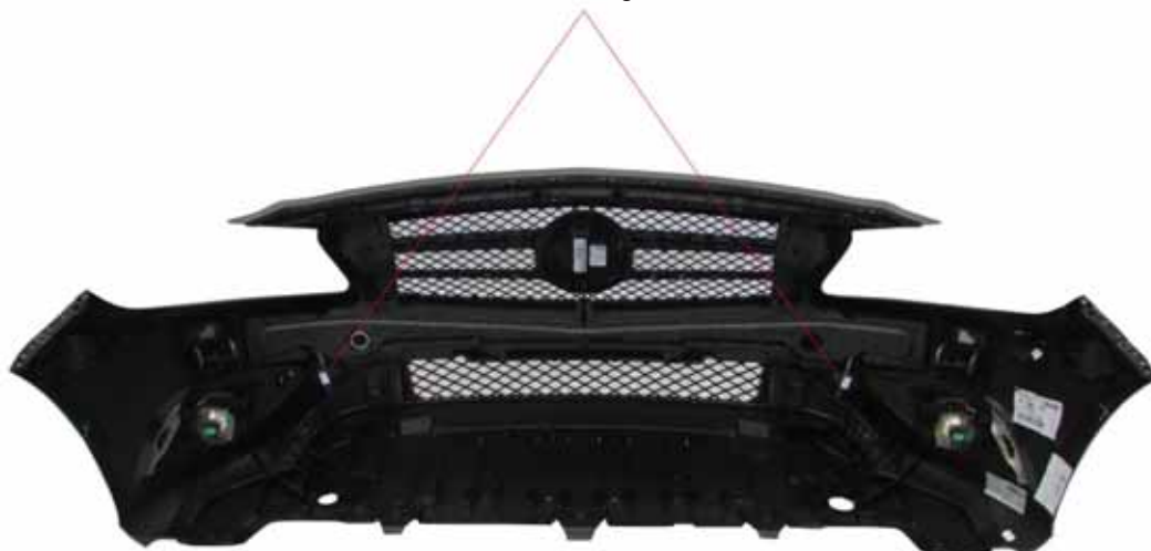
Sensores de activación de las bisagras
