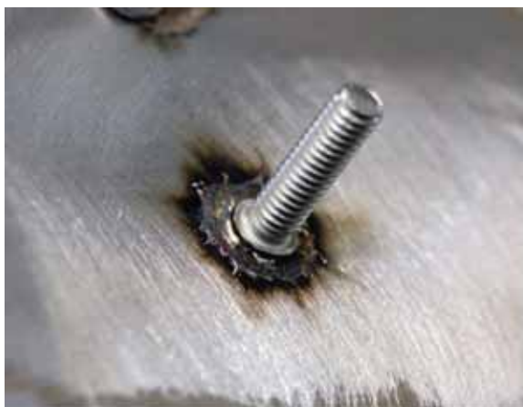
Soldadura de clavos
