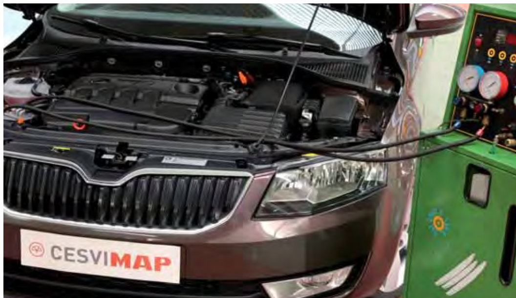
► Realización de una carga de gas fluorado
