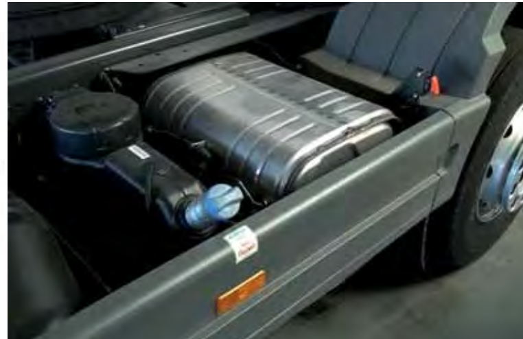
► Depósito de AdBlue y silenciador integrado-Mercedes Benz
