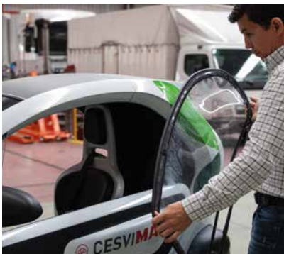
► Colocación del kit de ventanillas
