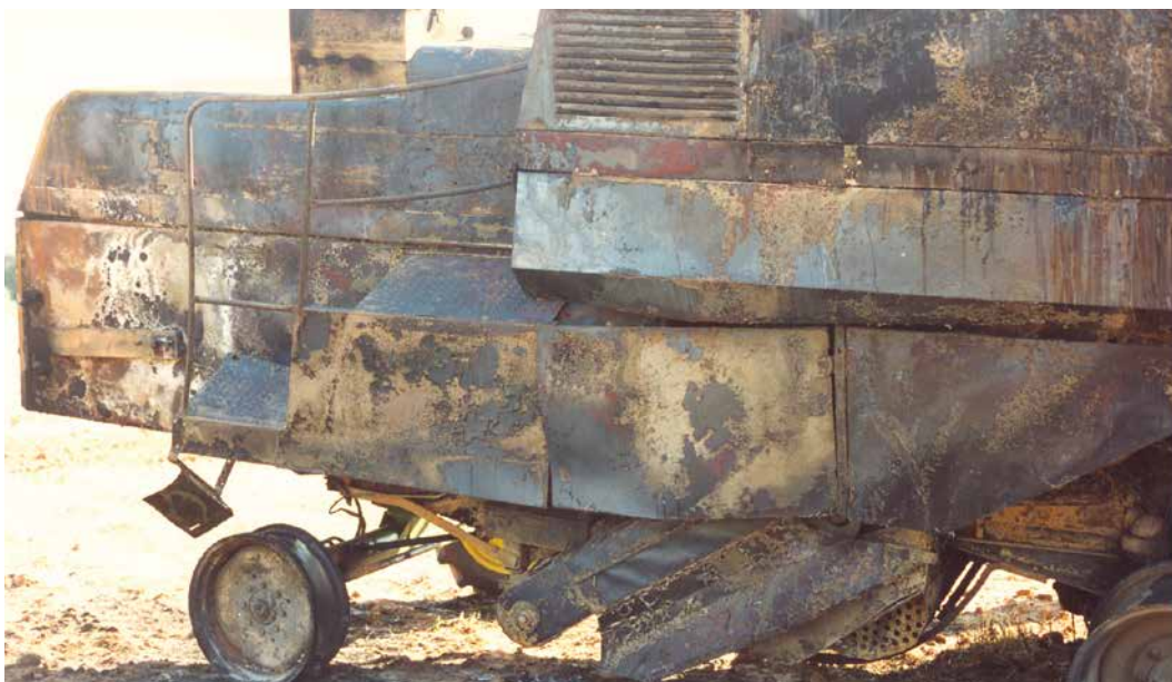
► Estado de la parte posterior de una cosechadora incendiada
