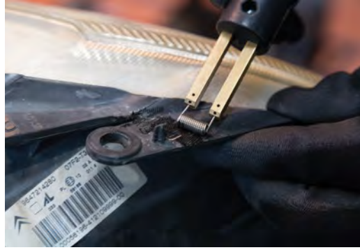
▶ Acabado con grapas en forma de espiral
