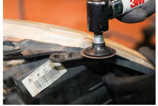
▶ Lijado de las partes sobrantes
