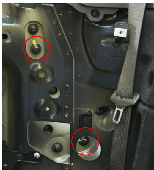
► Tornillos de la placa de anclaje
