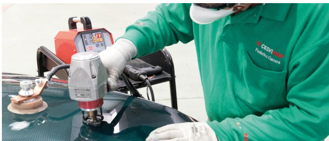
► Extracción de abolladuras con la herramienta AP 95
