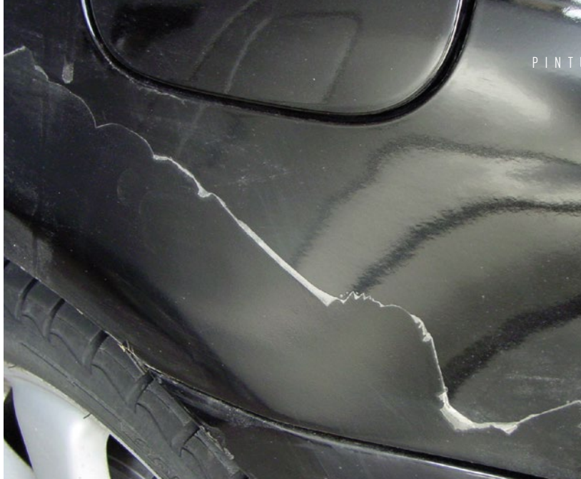
▶ Desprendimiento de pintura por falta de adherencia
