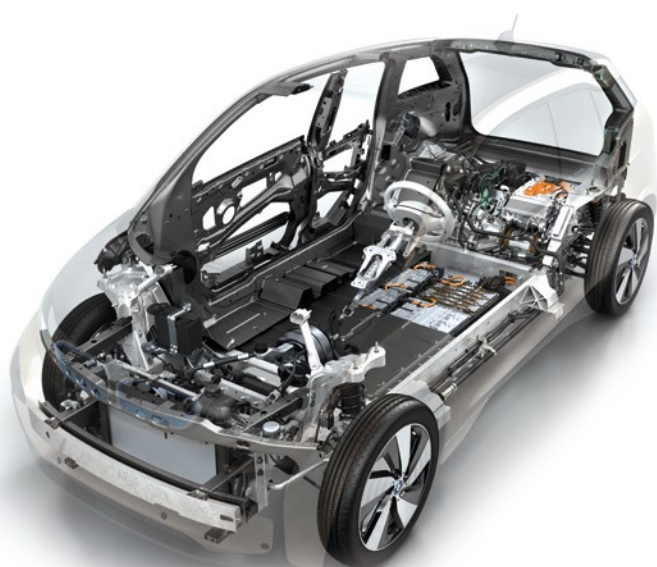
▶ Estructura y ubicación de la batería
