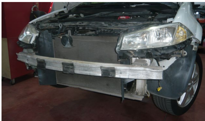
► Desmontaje del paragolpes delantero, previo al del faro
