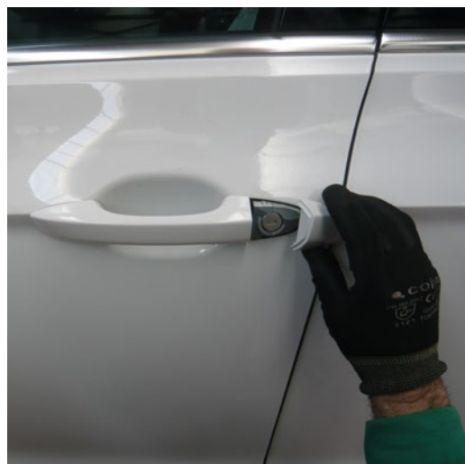
► Bombín de puerta, sin daños
