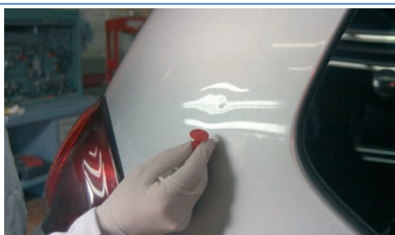
1 Identificación del daño y selección de la ventosa adecuada.
