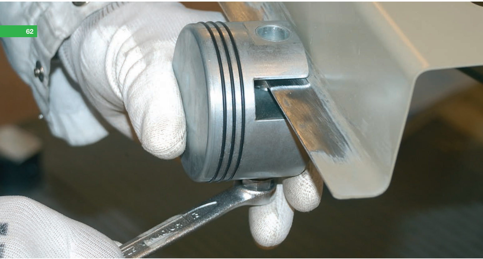
Colocación y fijación de la sufridera
