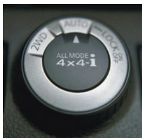
Detalle del pulsador del sistema All Mode 4x4-i.
