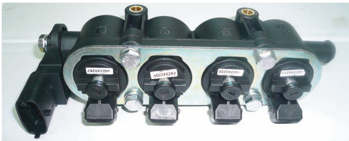
Válvulas de Inyección
