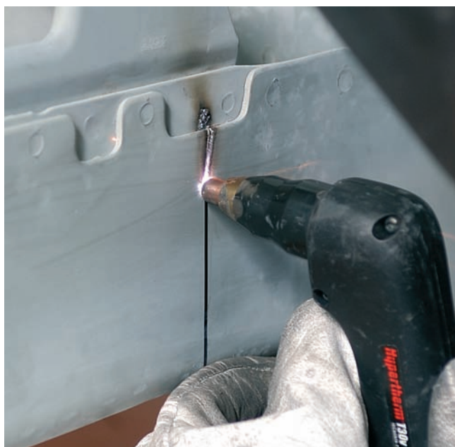
Sección parcial previa en un larguero delantero mediante corte por plasma
