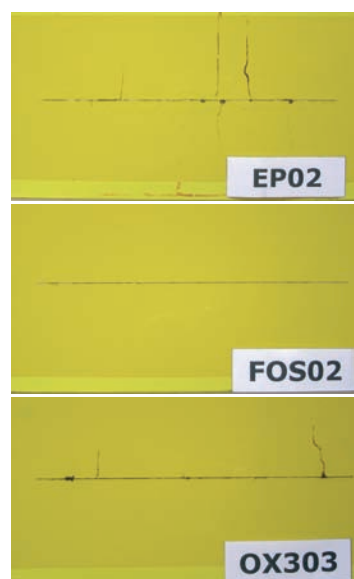
Algunas de las probetas ensayadas. De arriba a abajo: Epoxi, fosfatante y Oxsilan CR300.
