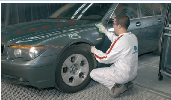
9 Eliminación de los restos de producto mediante un paño de microfibras.
