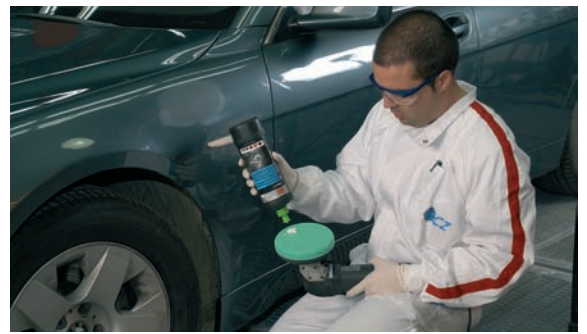
6 Pulido a máquina con compuesto de pulido y boina apropiada para eliminar las marcas de lijado. Con barnices resistentes al rayado, se emplea boina de lana o espuma rígida.
