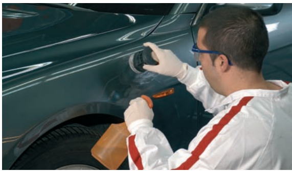
5 Lijado al agua con lija de granulometría P3000 o P4000 para un acabado más fino.
