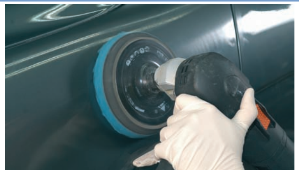
8 En el caso de colores oscuros es fácil que aparezcan hologramas, marcas circulares, después del proceso de pulido. En estos casos, se aplica un compuesto específico para eliminarlas.
