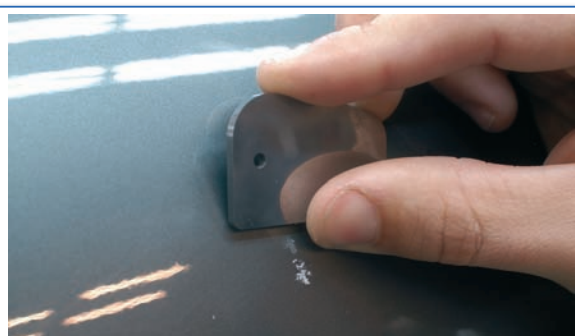
3 Eliminación de la mota de suciedad con una cuchilla especial, con cuidado de no desprender en exceso la pintura.
