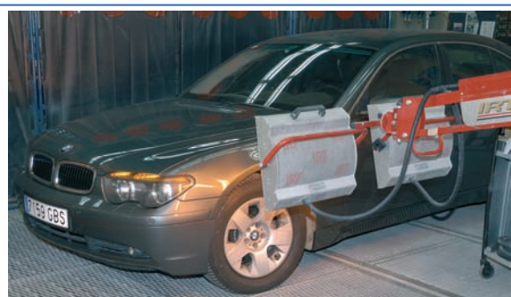
2 Es necesario asegurarse de que la capa de pintura está completamente endurecida. En ocasiones, puede ser necesario colocar durante un tiempo el equipo de infrarrojos para acelerar el secado.
