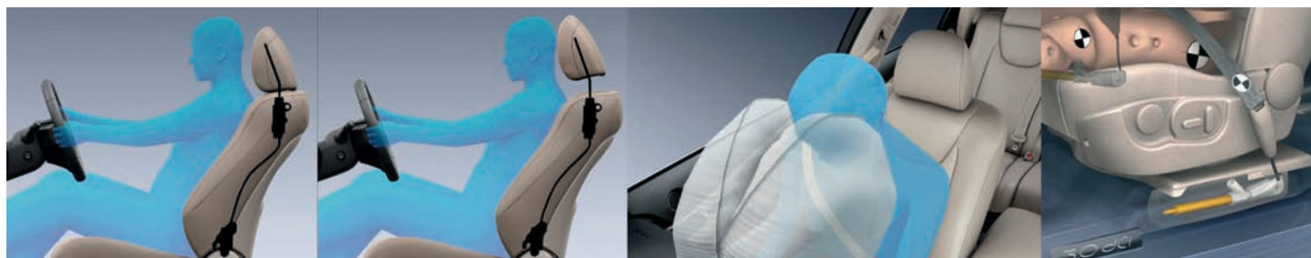
Airbags, pretensores y reposacabezas se preparan para la colisión inminente.
