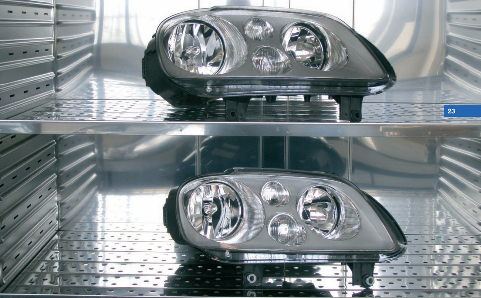
Conjuntos delanteros en la cámara climática.
