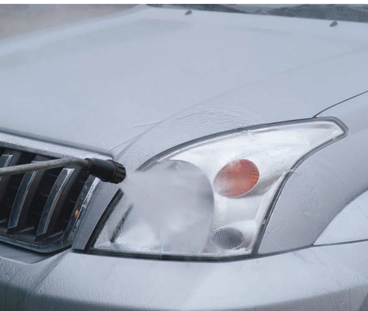
Prueba de lavado a alta presión.
