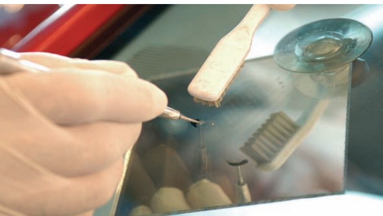
Limpieza del daño.
