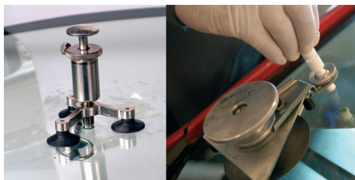
El inyector es el elemento fundamental del equipo de reparación de lunas.
