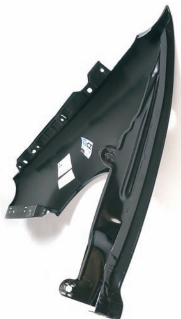
Se controla que las aristas de la pieza no presenten rebabas o aristas cortantes.
