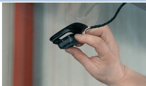
1 Separar el sensor de lluvia y luz del parabrisas.
