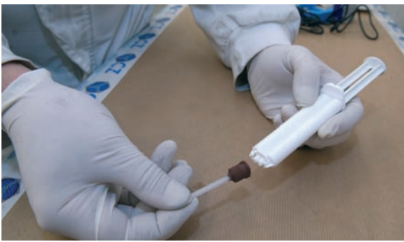
5 Preparar el aplicador (inyector) del gel colocando la boquilla mezcladora.
