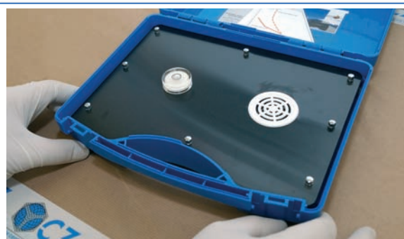
4 Colocar y nivelar el equipo de recuperación en posición horizontal.
