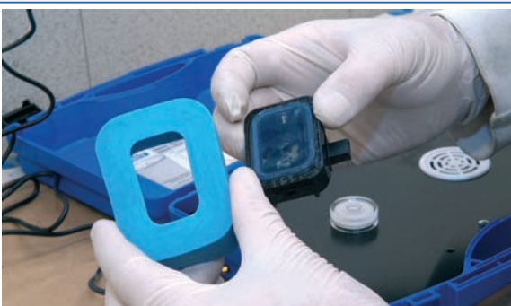
9 Retirar la plantilla y colocar el sensor con el nuevo gel en el parabrisas.
