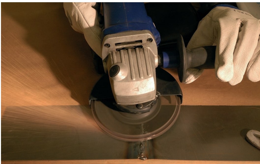
El disco multiláminas Control de Berner permite una visión directa de la zona a trabajar.
