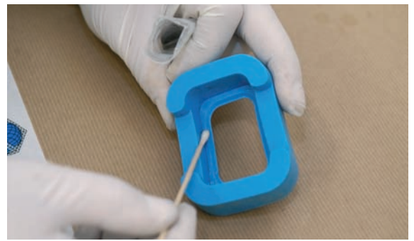
6 Aplicar a la plantilla que sirve como molde una delgada capa de desmoldeante.
