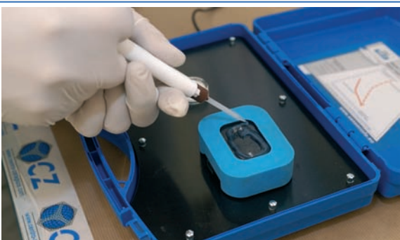
7 Colocar la plantilla sobre el sensor y a su vez éste sobre el equipo recuperador. Aplicar el nuevo gel sobre la superficie óptica del sensor.
