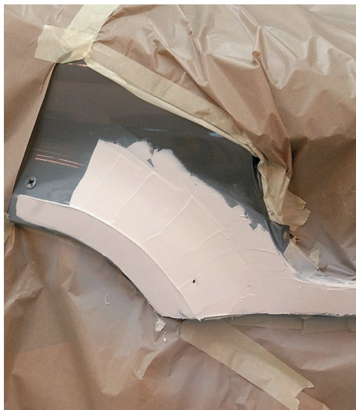
Aplicación de la masilla sobre la imprimación.
