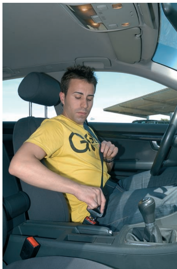
El sistema "Youth key" evita que el vehículo arranque si no hacen uso del cinturón de seguridad todos los ocupantes del vehículo.
