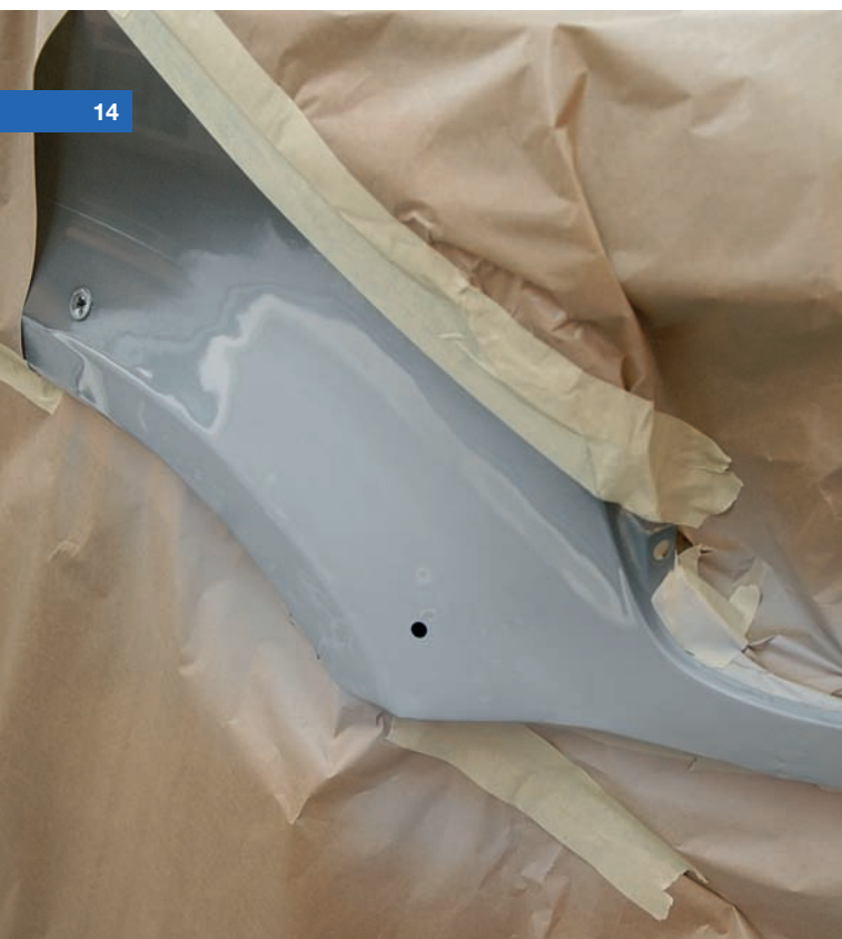
Imprimación epoxi aplicada para proteger el metal.
