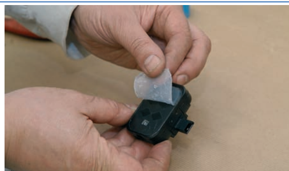
2 Retirar el gel residual del sensor.
