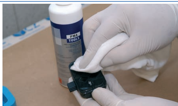
3 Limpiar la superficie del sensor con el limpiador específico y un paño de microfibra.
