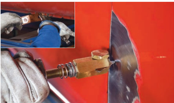
5 Colocar la masa y soldar la punta del martillo en el hundimiento de la chapa.
