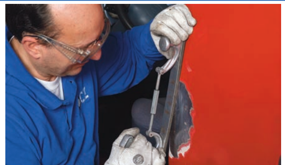
8 Comprobación de la reparación mediante la lima.
