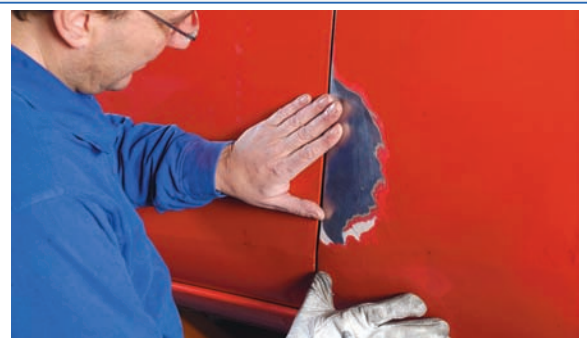
10 Comprobación final del resultado de la reparación.
