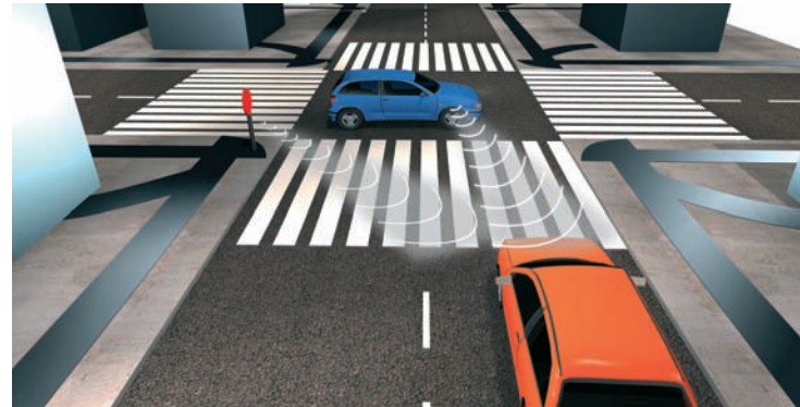
La tecnología de comunicación vehículo-vehículo y vehículo-infraestructura, es la base de estos sistemas.
