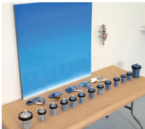
Preparación de los básicos de mezcla que integran el degradado.
