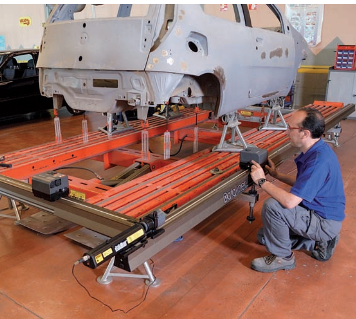
Bancada Dataliner con sistema de medición óptico.
