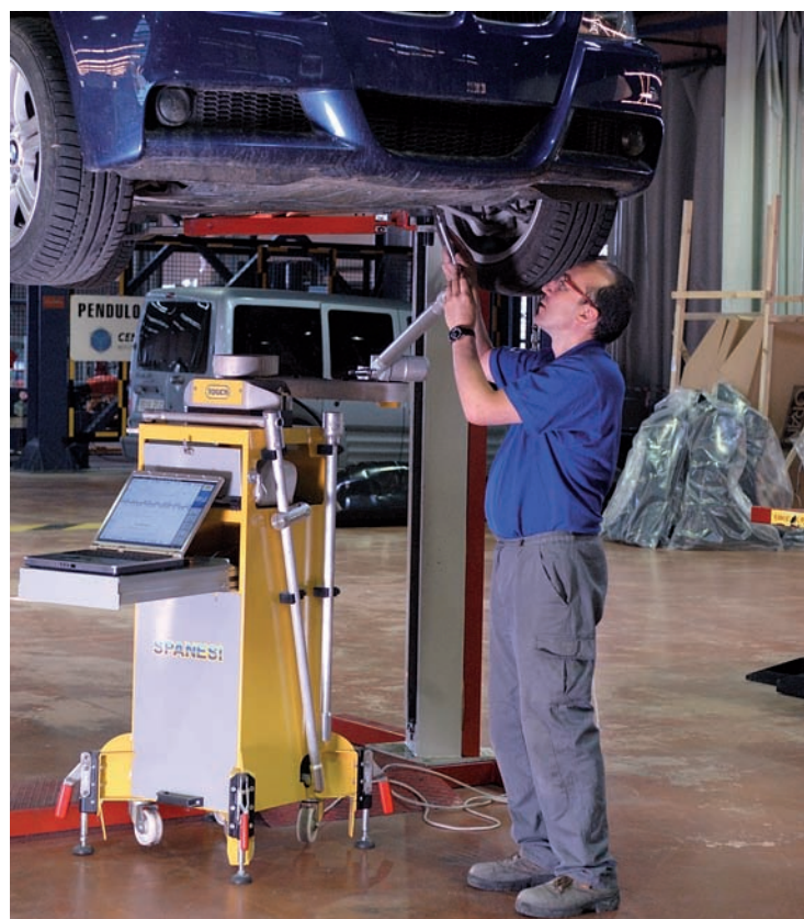
Sistema de medición electrónico monopunto Touch, de Spanesi.
