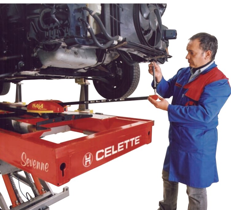
Sistema de medición electrónico monopunto Naja, de Celette.
