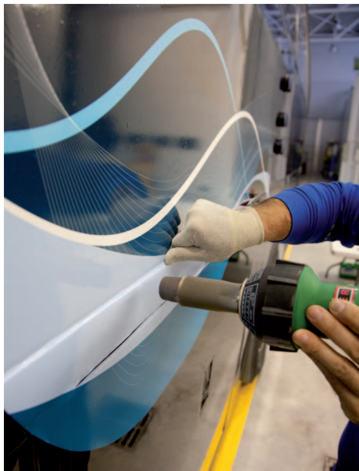
Calentamiento del vinilo para adaptarlo al relieve de la superficie.
