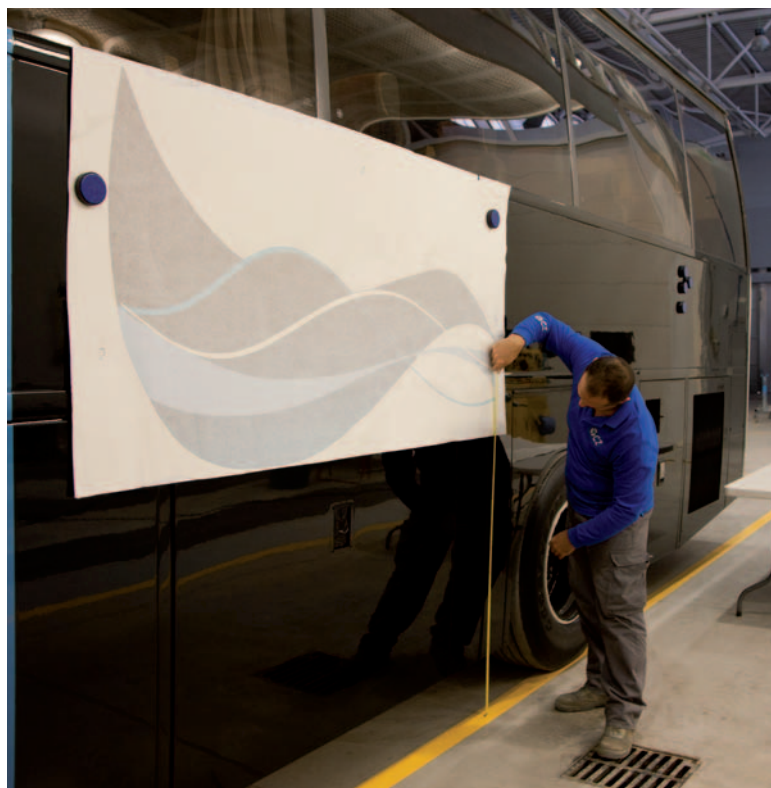
Posicionamiento previo del vinilo.
