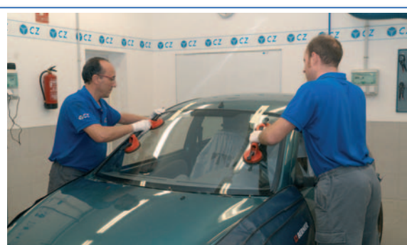
10 Montar la luna sobre el vehículo y guardar el tiempo de secado del adhesivo hasta su entrega.
