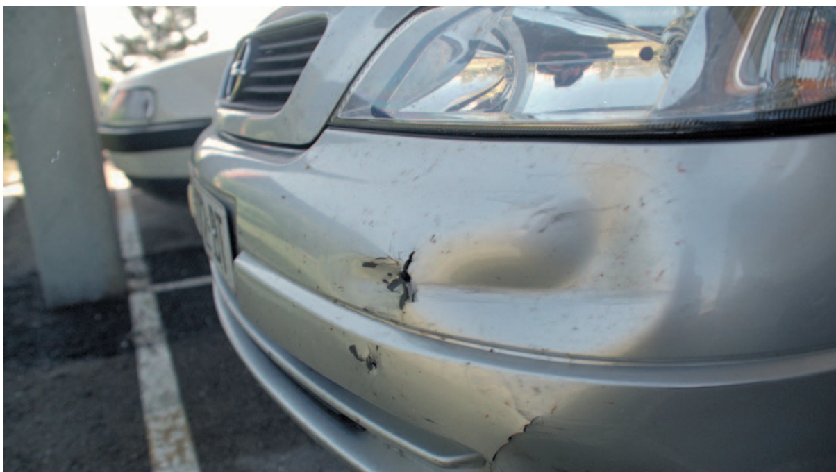
Daños visibles en un paragolpes debido a un impacto medio.
