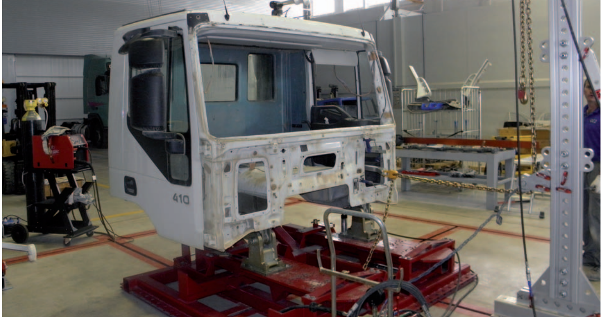
Bancada de reparación de cabinas Cab Bench, de Josam.
