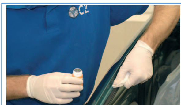
7 Limpieza y aplicación del promotor de adherencia adecuado a los sustratos presentes en el marco de la carrocería. (*)
