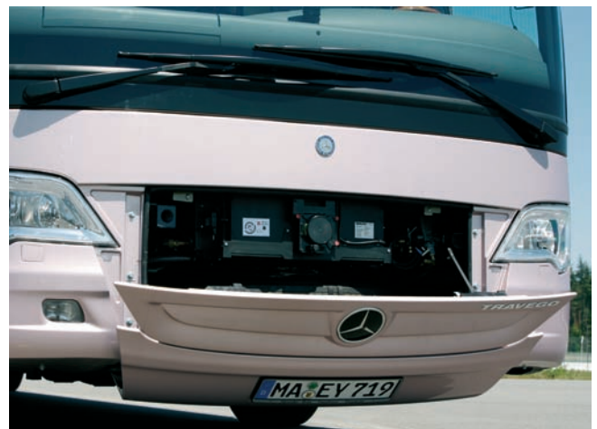
Existen sensores que detectan al vehículo que le precede.
