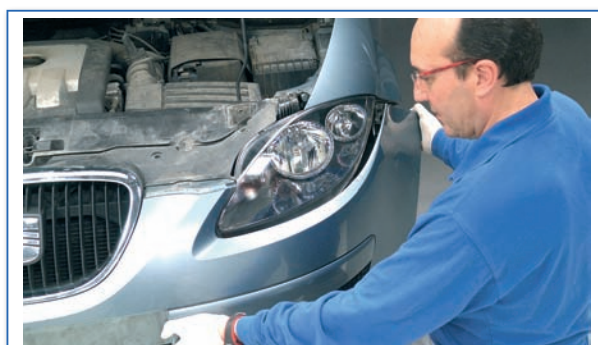
9 Montaje final del faro en el vehículo.
