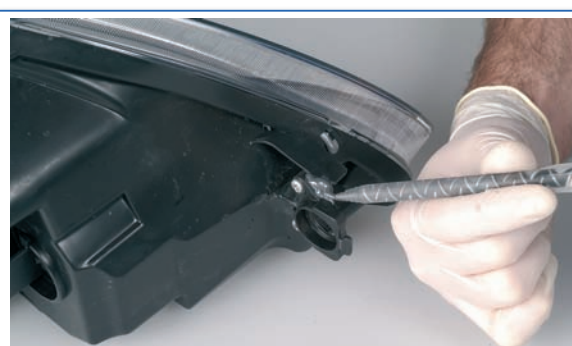
8 Mejora del acabado (adhesivo, pintado, etc) de la zona de unión entre la patilla y la carcasa.
