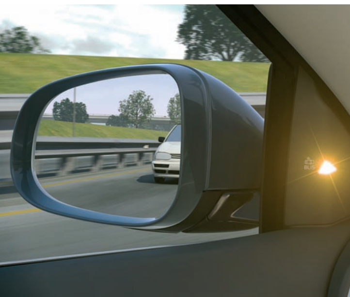
Sistema de detección de ángulos muertos (BLIS).
