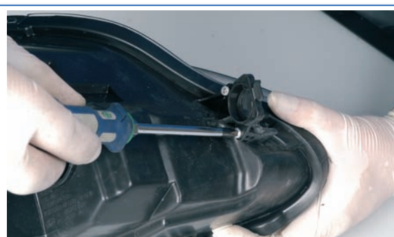
6 Ajuste y fijación de la patilla nueva en la carcasa del faro
