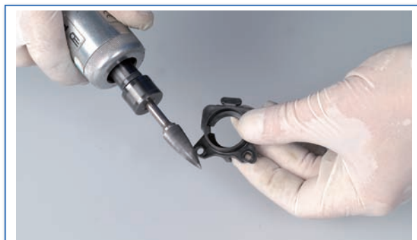
5 Preparación de de la superficie en la patilla nueva (si es necesario).
