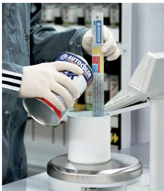
Adición del catalizador a la pintura de acabado.
