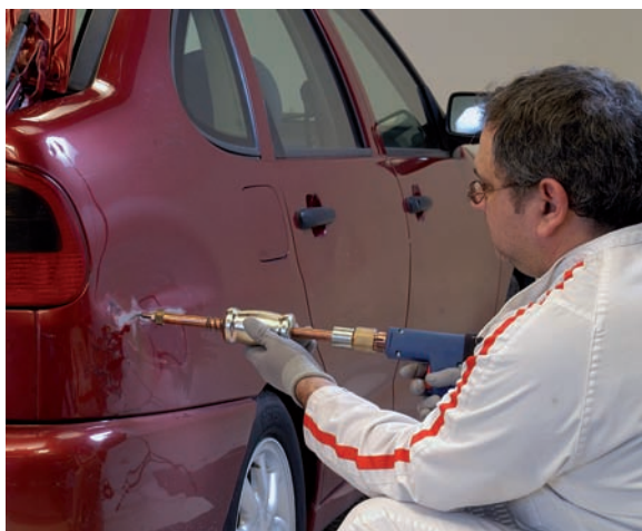
Desabollado de la chapa desde el exterior.
