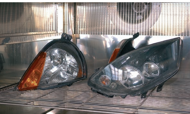
Distintos tipos de alumbrado dispuestos en el interior de la cámara climática.
