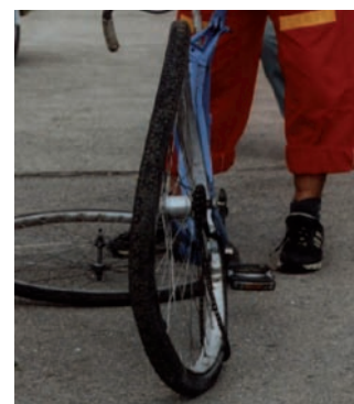
Daños característicos en la rueda trasera de la bicicleta, debidos a una colisión con la configuración mostrada en la imagen de arriba.
