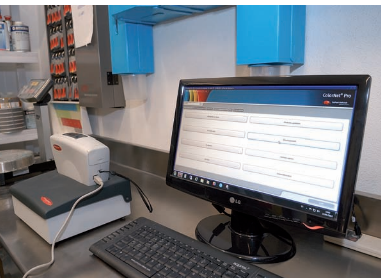
Conexión del espectrofotómetro al programa de gestión.
