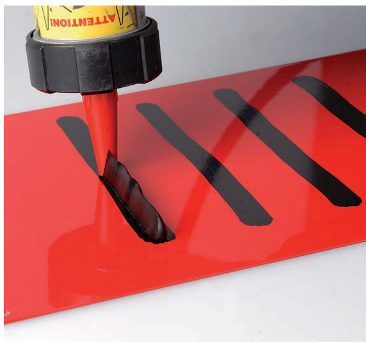
Aplicación del adhesivo en las probetas a ensayar.
