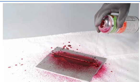
Aplicación del penetrante.
