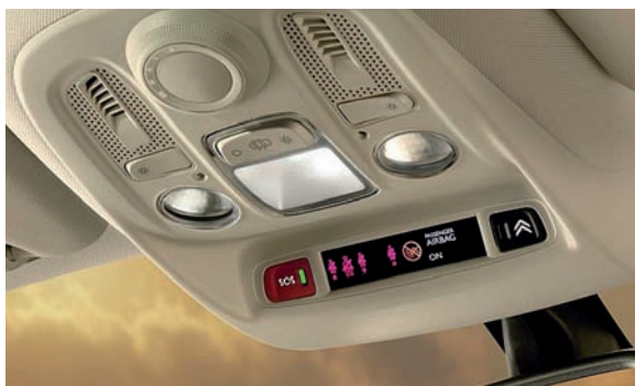
El sistema eCall conecta directamente el vehículo con los operativos de emergencia.
