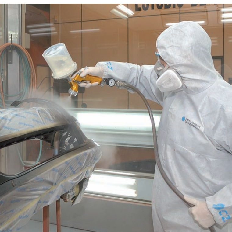
Enmascarado para la aplicación de la pintura de acabado.
