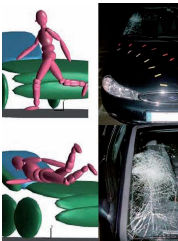
Análisis biomecánico de un atropello a un peatón a 35 km/h.
