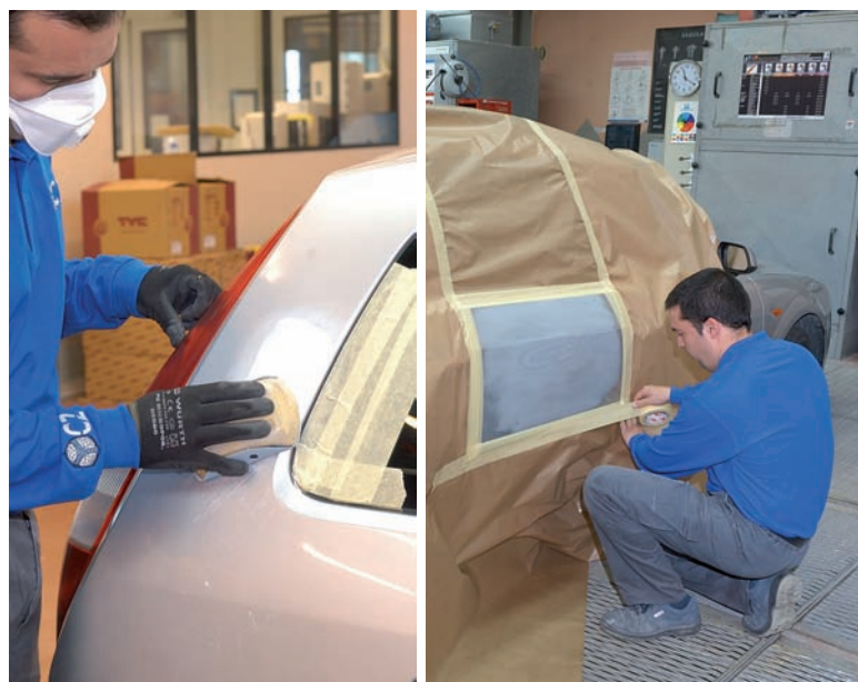
Enmascarado para proteger del lijado de la masilla y de la aplicación de aparejo.
