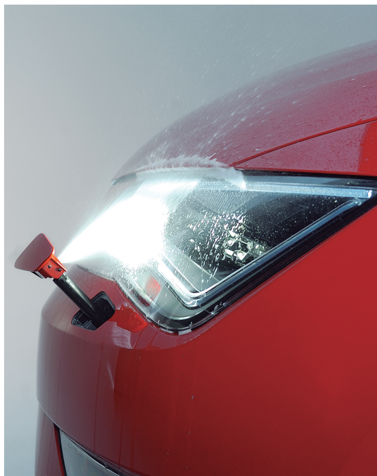
Los dispositivos de limpieza son necesarios para un flujo superior a 2000 lumen.
