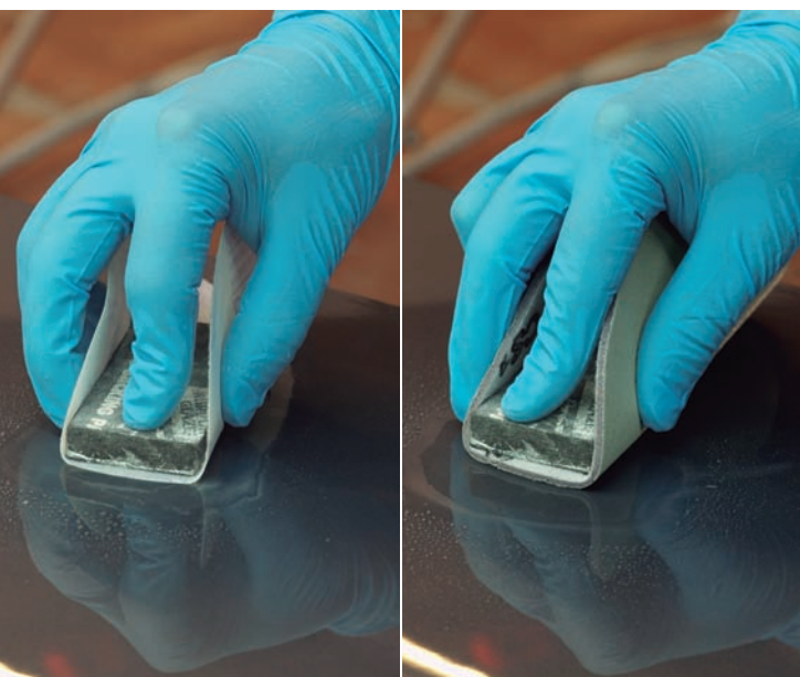
Lijado para la eliminación del daño.
