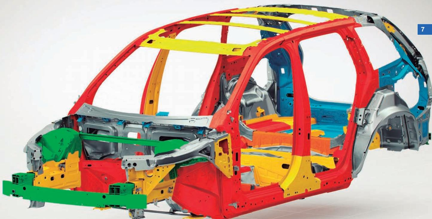
El resultado de ello es la aparición de dos nuevas técnicas de fabricación de piezas denominadas *"Tailored Welded Blank"* y *"Tailored Rolled Blank"*, que permiten fabricar piezas con espesor variable.
