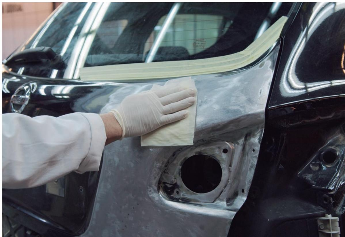
Bonderite 1455-W sobre el metal sólo asegura una perfecta protección contra la corrosión cuando se aplica a continuación un recubrimiento adicional, es decir, que por sí sola no protege, siendo imprescindible aplicar a continuación un tratamiento como cataforesis (en fabricación), aparejo, masilla, imprimación o masilla pulverizable.
