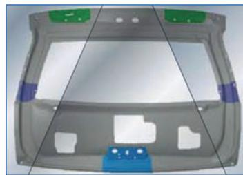
*Inclusión de refuerzos en el portón usando la técnica Tailored Welded Blank.*
