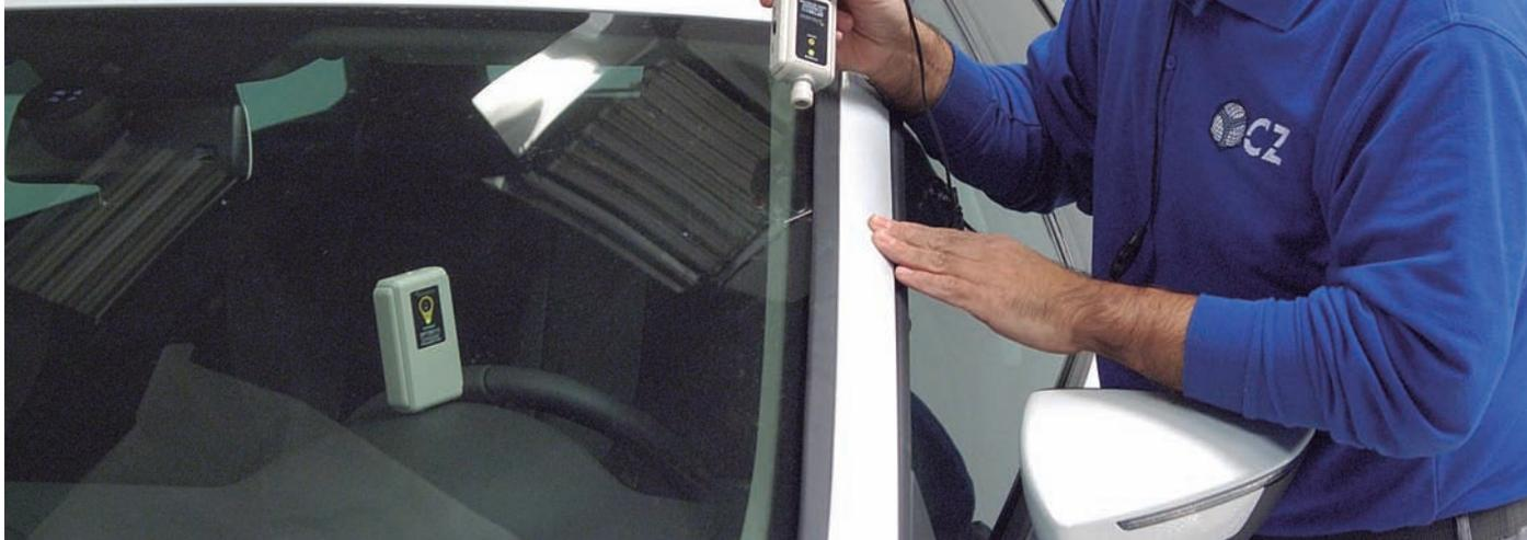
El Detector de Ultrasonidos de Spanesi dispone de una sonda que permite la detección de fugas de aire, agua y polvo en el interior de los vehículos, evitando las filtraciones de agua en el cambio de lunas, así como los ruidos molestos de viento en las puertas o portones. Es de fácil manejo, con dos métodos de detección, acústico mediante auriculares y visual a través de led. Además, dispone de un mando para ajustar la sensibilidad del equipo.
