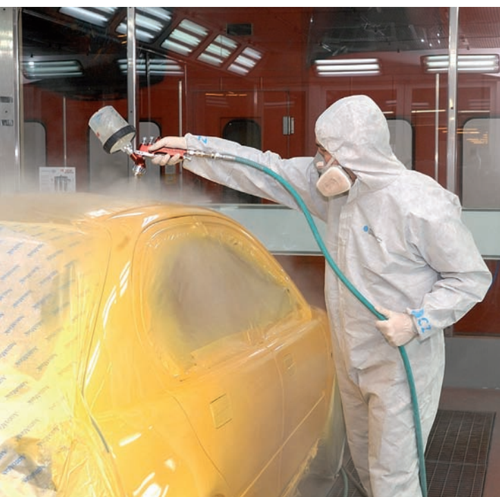
Aplicación de pintura en la cabina con los equipos de protección individual necesarios.
