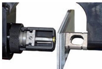
Punzonador para la realización de orificios, incluso en aceros de ultra alta resistencia.
