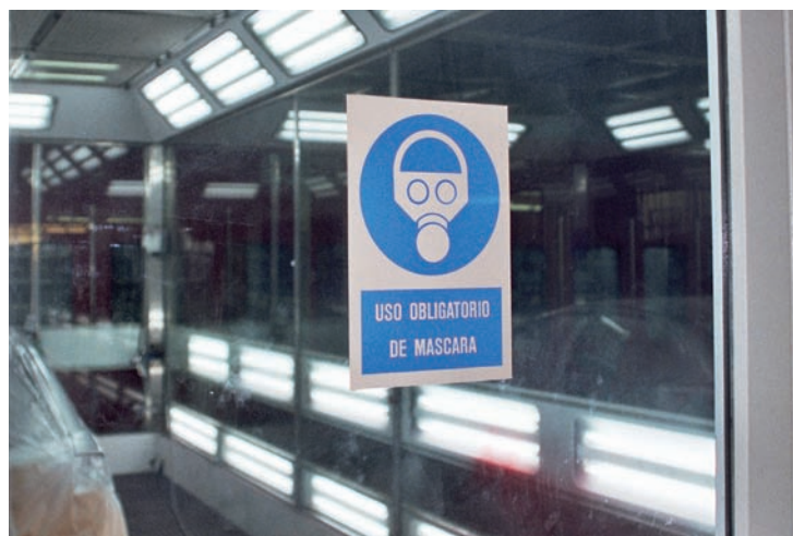
Señalización de uso obligatorio de mascarilla.
