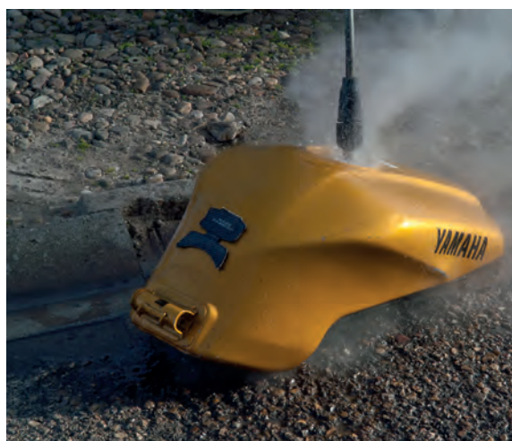
Proceso de desgasificado.
