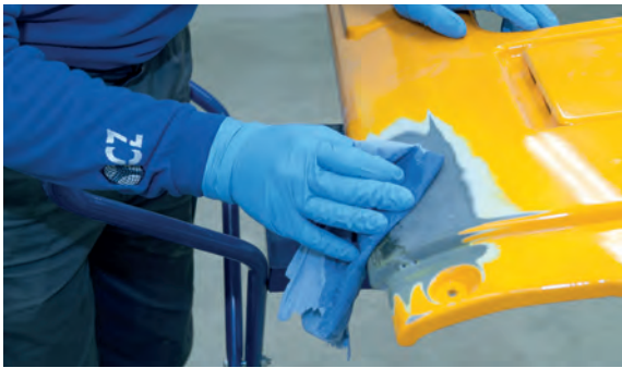
5 Limpiar la superficie de pegado con disolvente.
