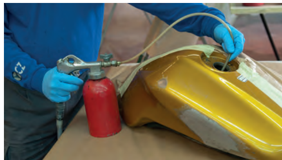
Aplicación interior de imprimación anticorrosiva.
