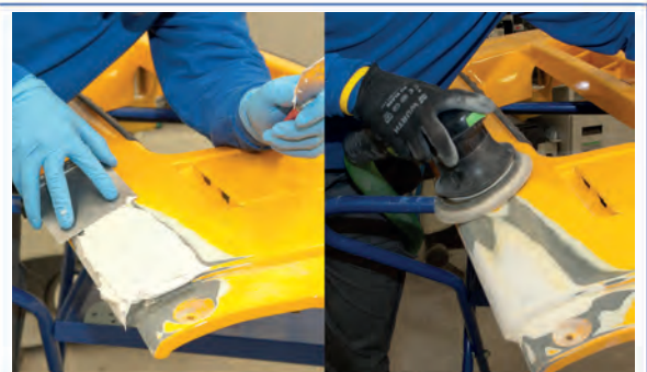
10 Acabado final mediante aplicación de masilla y lijado.
