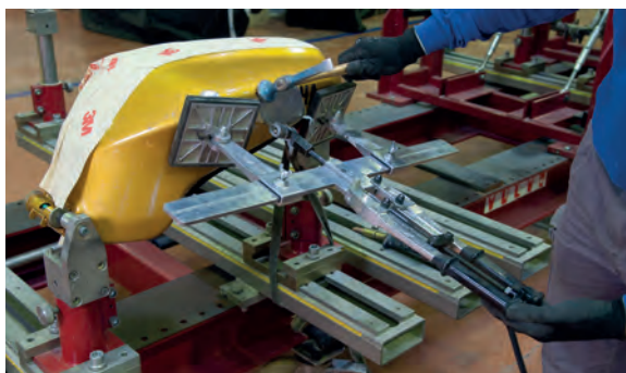
Estiraje del daño mediante el puente.
