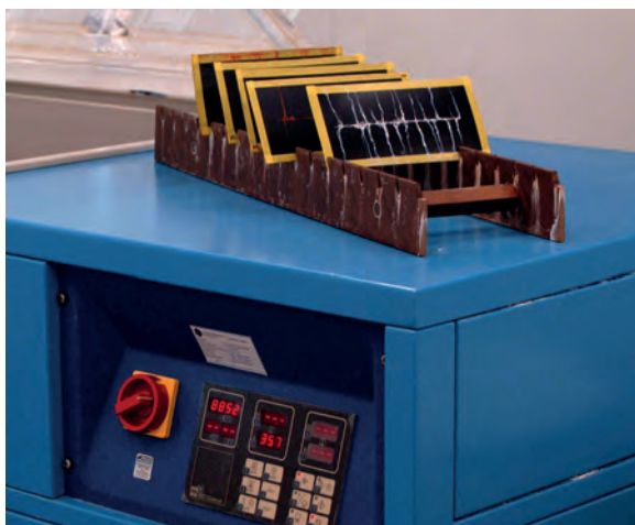
Ensayo de corrosión en cámara de niebla salina.
