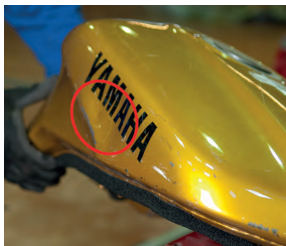
Daño en un depósito de combustible de motocicleta.
