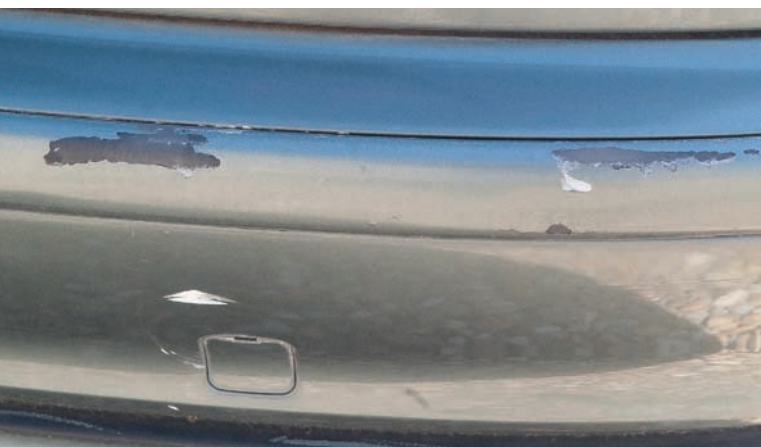
Problemas de adherencia.
