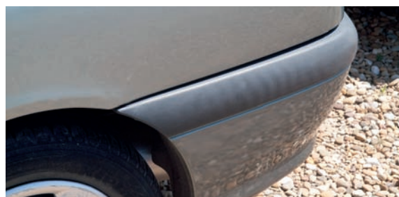
Plástico degradado por el sol.
