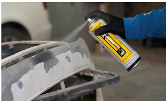
Aplicación de imprimación de anclaje.
