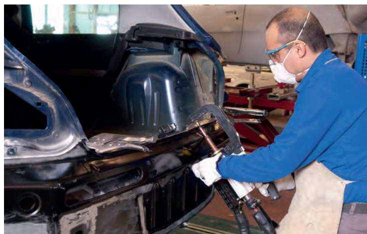
Unión por soldadura.
