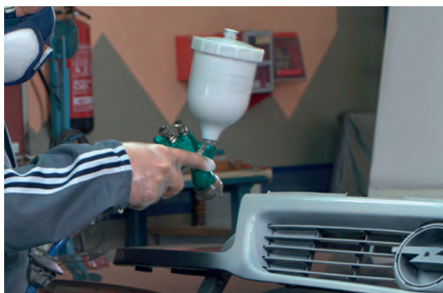
Aplicación de aparejo en pieza nueva no imprimada.
