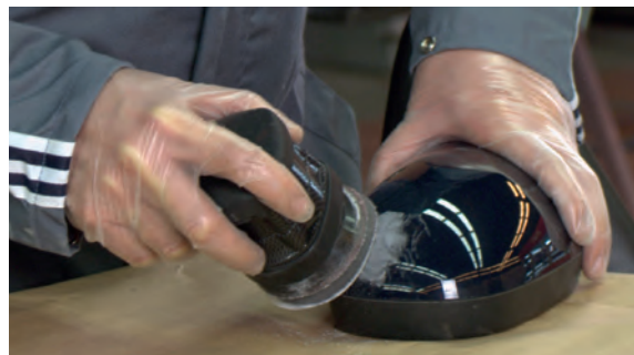
Lijado de arañazo con esponja abrasiva.
