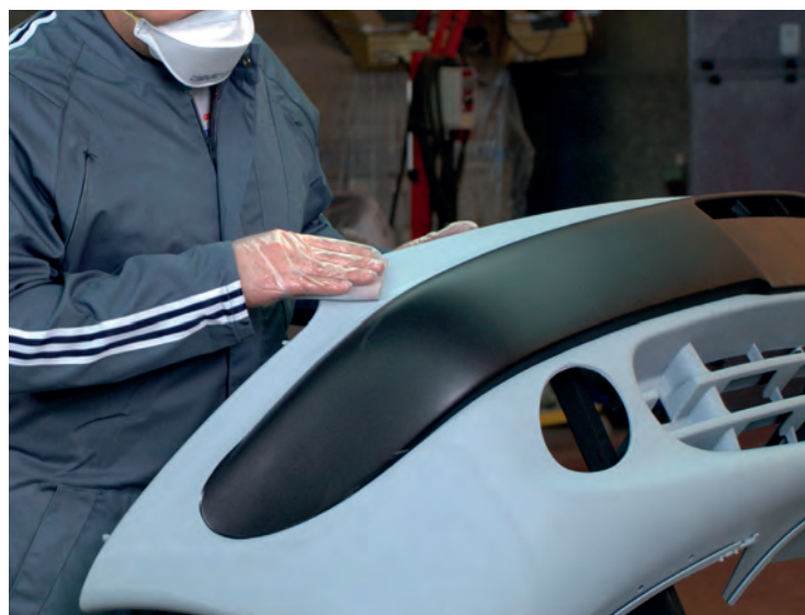
Matizado de la imprimación-aparejo de origen.
