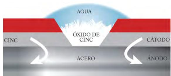
*Ante la presencia de un fallo en los recubrimientos, en el acero galvanizado se oxida el cinc y el acero queda protegido.*
