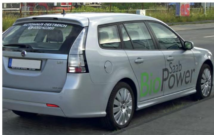
El sistema Flex-Fuel utiliza como combustible el etanol, pudiendo afectar negativamente a elementos del motor como la bomba para la inyección, el rail, inyector, etc., por lo que se hace necesario reforzarlos. Además, requiere una calibración de la unidad de control, lo cual incrementa el coste del sistema.
