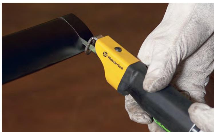
La sierra alternativa neumática permite al chapista realizar secciones parciales en las piezas de forma sencilla, con bastante precisión y alineación, sin provocar chispas que podrían dañar elementos interiores tales como guarnecidos o revestimientos.
