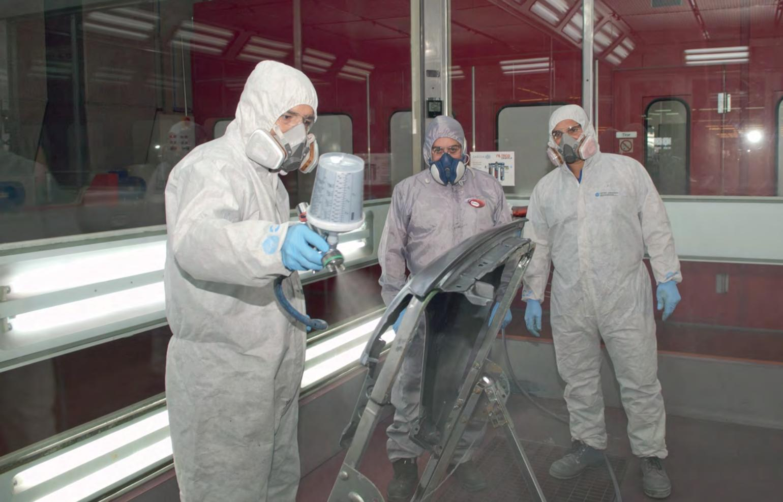
Este aparato se pudo probar en el taller mediante una serie de aplicaciones sobre diferentes piezas, resultando un producto fácil de aplicar y con un tiempo de secado en cabina a 60°C de 20 minutos.
