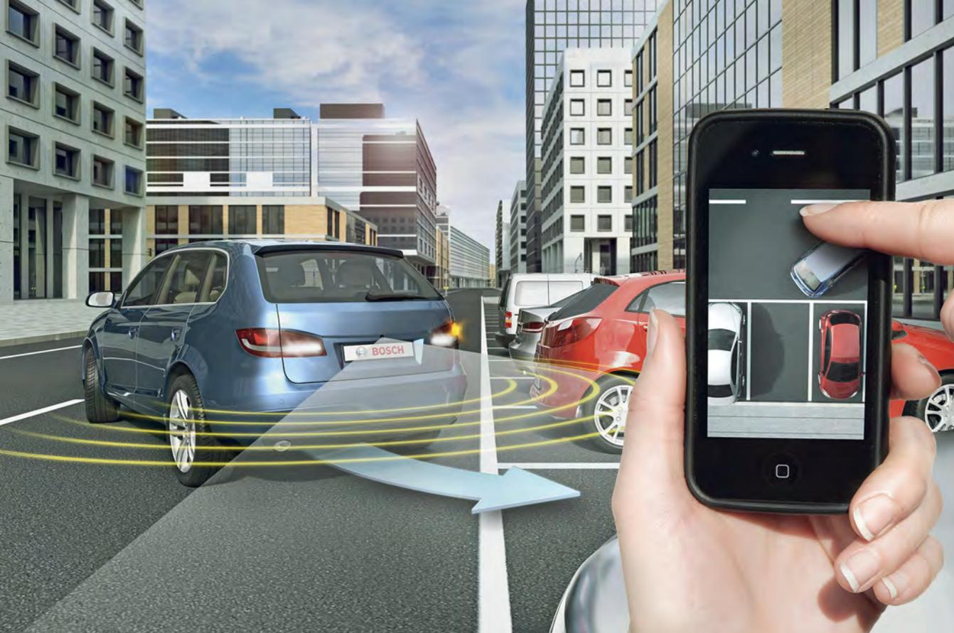
Para realizar esta función, el vehículo utiliza los sensores de ultrasonidos situados en los laterales, que le permiten detectar la presencia de objetos a un lado del vehículo, así como calcular el tamaño de los huecos que va encontrando en función de la velocidad a la que circula el vehículo.
