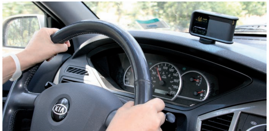
El Mini Coyote avisa con 750 metros y dos kilómetros de antelación de la presencia de radares fijos y móviles respectivamente. Gracias a su conexión a internet por GPRS, permite avisar en tiempo real de los radares móviles avistados por otros conductores.
