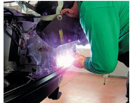
Soldadura del faldón
