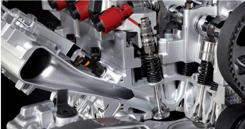
La tecnología MultiAir es un sistema electrohidráulico que sustituye a la tradicional mariposa y cuyo objetivo incrementar el rendimiento energético del motor.
