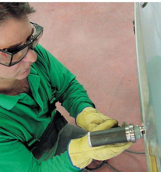
Soldadura de los pernos
