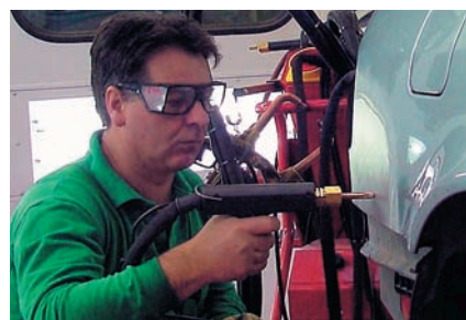
Recogido de chapa y repaso con lima
