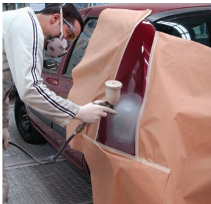
Aplicación de imprimación epoxi
