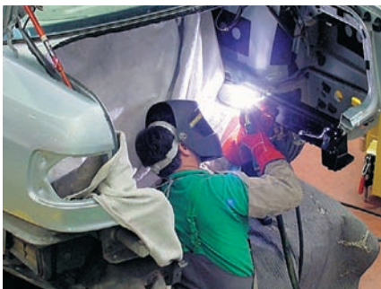
Soldadura del larguero
