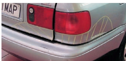
Daños en las piezas de aluminio
