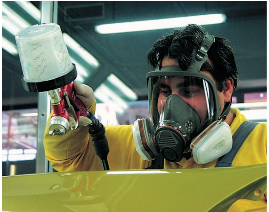
Aplicación de pintura con máscara completa
