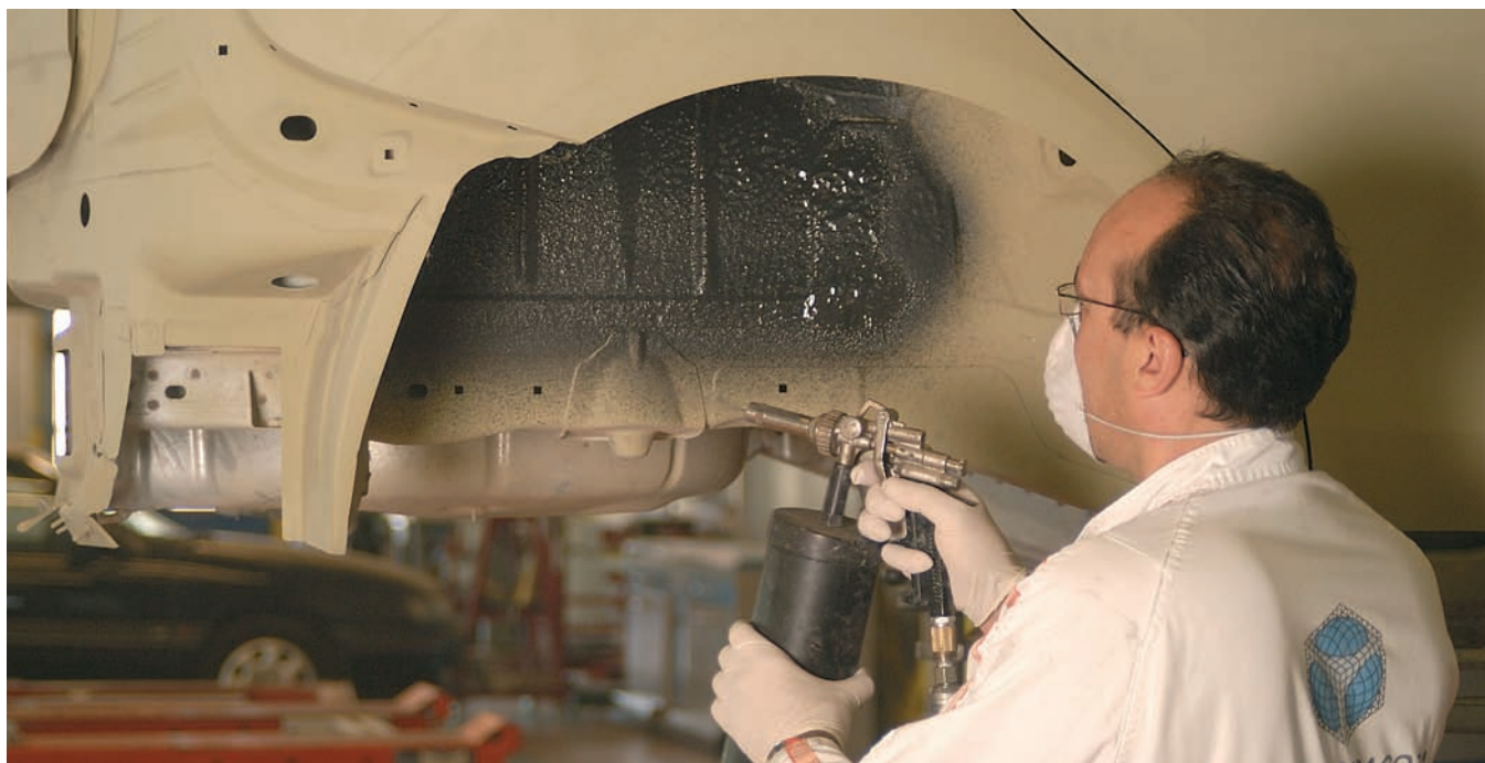
▲ Antigravillas: Productos que se aplican en estribos bajo puerta, cantoneras, spoilers, faldones traseros y pases de rueda.
