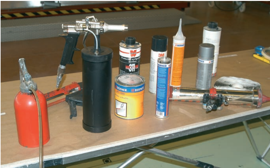
▲ Diferentes productos anticorrosivos: imprimaciones electrosoldables, masillas y selladores de estanqueidad, revestimientos de bajos y cera de cavidades.
