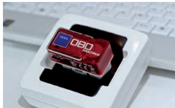
Dispositivo para la diagnosis a bordo OBD Matrix.
