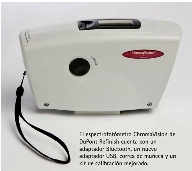
El espectrofotómetro ChromaVision de DuPont Refinish cuenta con un adaptador Bluetooth, un nuevo adaptador USB, correa de muñeca y un kit de calibración mejorado.
