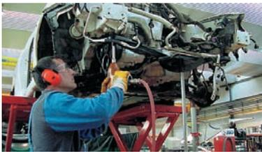
*Desmontaje de los conjuntos mecánicos*
