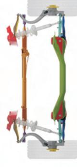
DS Check es una aplicación muy sencilla de manejar e intuitiva. El profesional podrá escoger directamente la clase de suspensión con la que ha de trabajar o recurrir a la marca y modelo del vehículo, asignando automáticamente la aplicación el tipo de suspensión trasera y delantera de ese modelo concreto.
