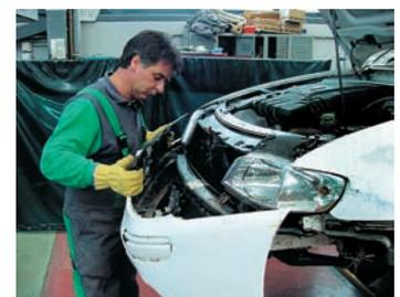
*Desmontaje de las piezas exteriores*
