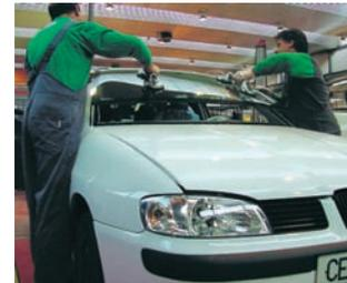
*Montaje de los elementos acristalados*
