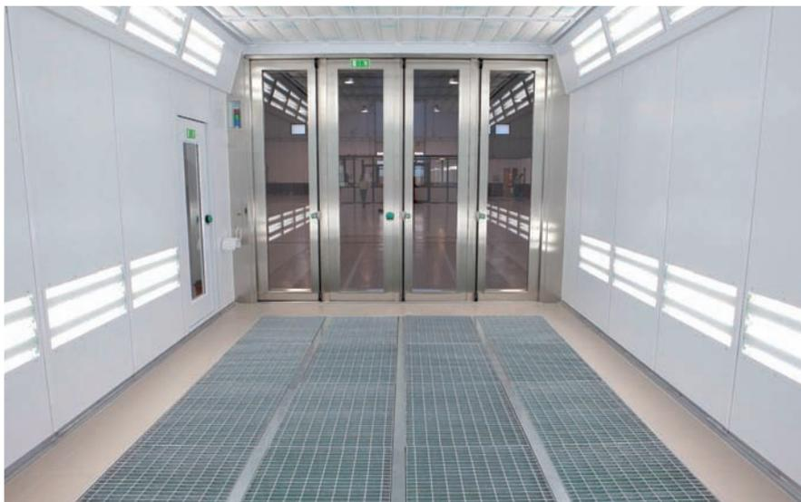
equipamiento: dos cabinas CMC serie INOX de última generación, con sistema setting para poder hacer secado y pintados parciales al vehículo; además de tener inverters de impulsión y extracción, cuenta con grupos en el techo totalmente aislados e insonorizados, un cuadro táctil que permite elegir cualquier tipo de secado y la programación de cualquier marca de pintura, conectado vía internet para poder controlar el servicio posventa.
