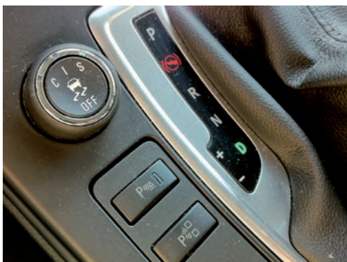
Los modos de conducción del Saab Drive Sense se seleccionan mediante un botón giratorio ubicado a la izquierda del cambio.
