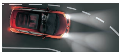
Sistema de luces direccionales
