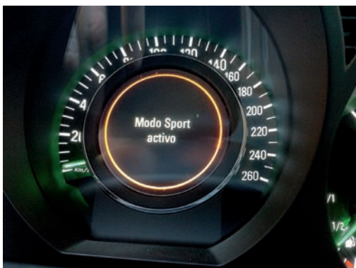
El modo de amortiguación escogido se muestra en el cuentakilómetros.
