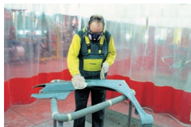
Limpieza tras el lijado del aparejo
