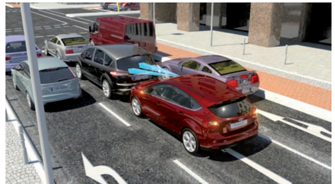
El Active City Stop puede evitar un buen número de los típicos pequeños choques a baja velocidad que se producen en las zonas urbanas, ya sea por despistes, frenazos bruscos del de delante, etc
