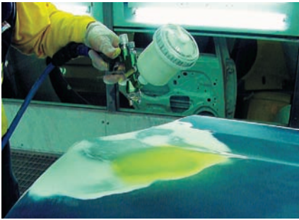
Aplicación de pintura con máscara completa
