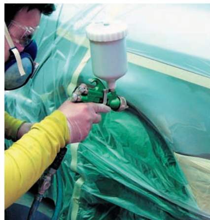
Imprimación epoxi, previa al masillado, sobre aluminio
